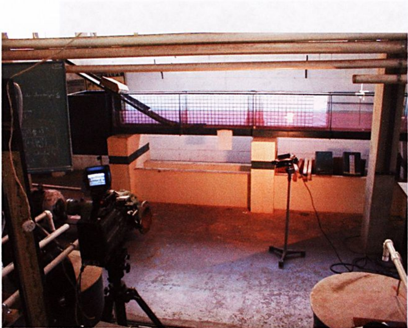
Figura 11 - Esquema de filmagem no laboratório (câmera de vídeo, iluminação, malha)
