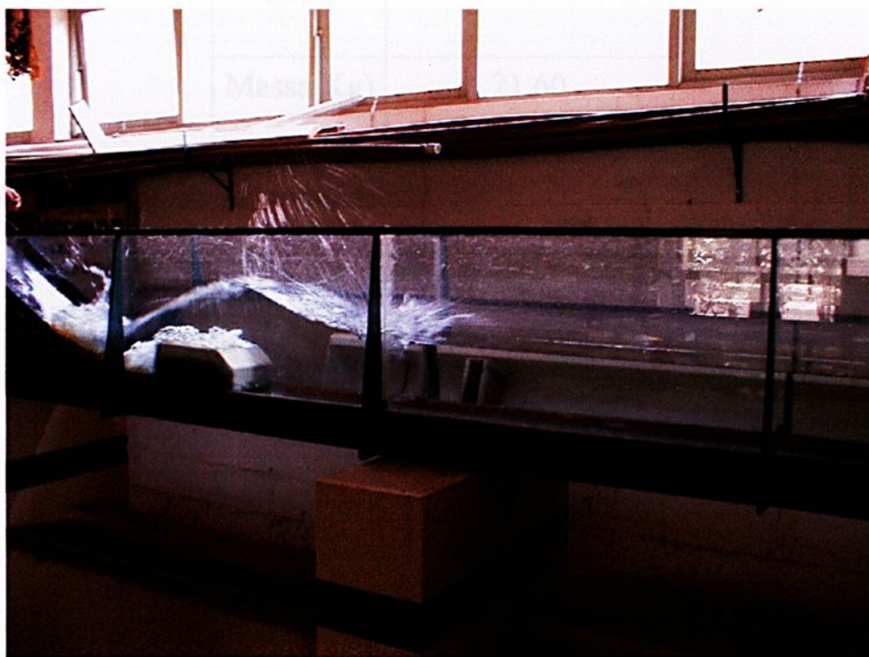
Figura 9 - Esquema de lançamento do corpo sólido formando ondas de submersão – Zona de Geração -
