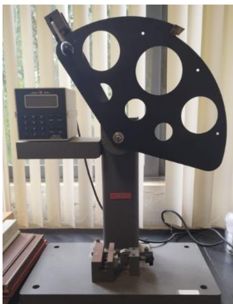
Figura 16 - Equipamento da Tinius Olsen, modelo 892, utilizado para a realização dos ensaios de impacto com pêndulo.
