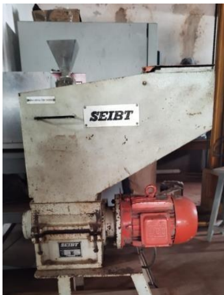
Figura 12 - Moinho de facas Seibt MGH 6/230, utilizado para a cominuição dos compósitos fabricados.
