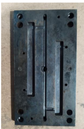
Figura 14 - Molde utilizado para a injeção de corpos de prova para os ensaios de flexão de três pontos conforme a norma ASTM D790-17.
