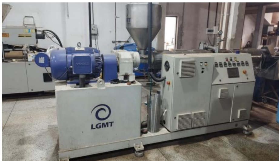
Figura 10 - Extrusora monorosca da marca LGMT, modelo LGEX - SIV 0V 060/36D, utilizada para a fabricação dos compósitos em regime contínuo.
