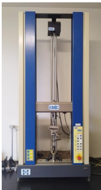
Figura 15 - Equipamento da Emic DL-3000 para a realização de ensaios de tração e de flexão, com a configuração para o ensaio de tração.
