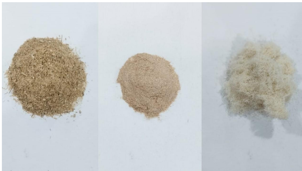
Figura 18 - Apresentação das fibras utilizadas no projeto. À esquerda, as fibras de bambu como obtidas do fornecedor. No centro, as fibras de eucalipto micronizadas e à direita as fibras de sisal também obtidas após a micronização.
