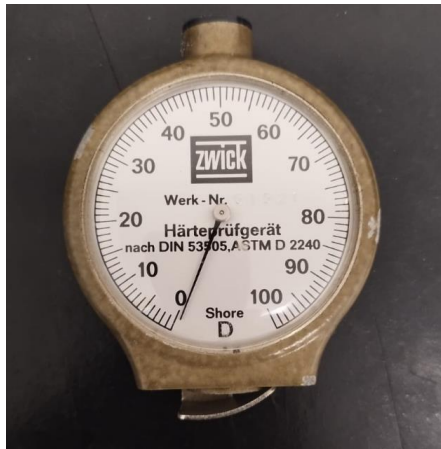
Figura 17 - Durômetro da Zwick, utilizado para a realização dos ensaios de dureza Shore D.
