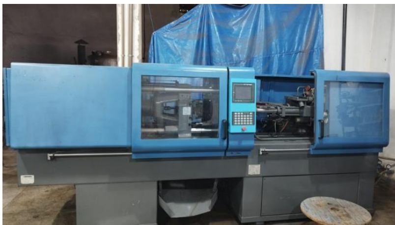
Figura 13 - Injetora de plásticos da marca Semeraro, modelo 650/247, utilizada para a injeção dos corpos de prova conforme as normas ASTM.
