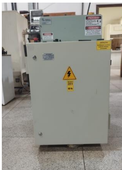
Figura 11 - Homogeneizador Draiz da MH Equipamentos, modelo MH-100, utilizado para a fabricação dos compósitos em batelada.
