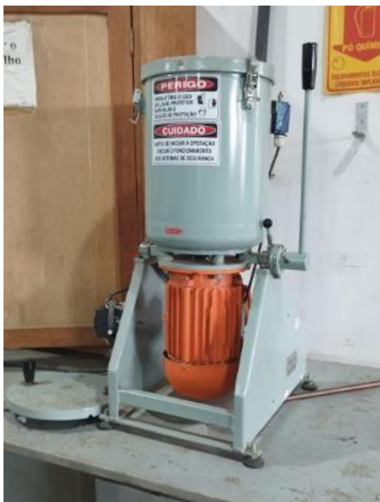
Figura 9 - Misturador da marca MH Equipamentos, modelo MH-4, utilizado para a mistura mecânica dos componentes da formulação.
