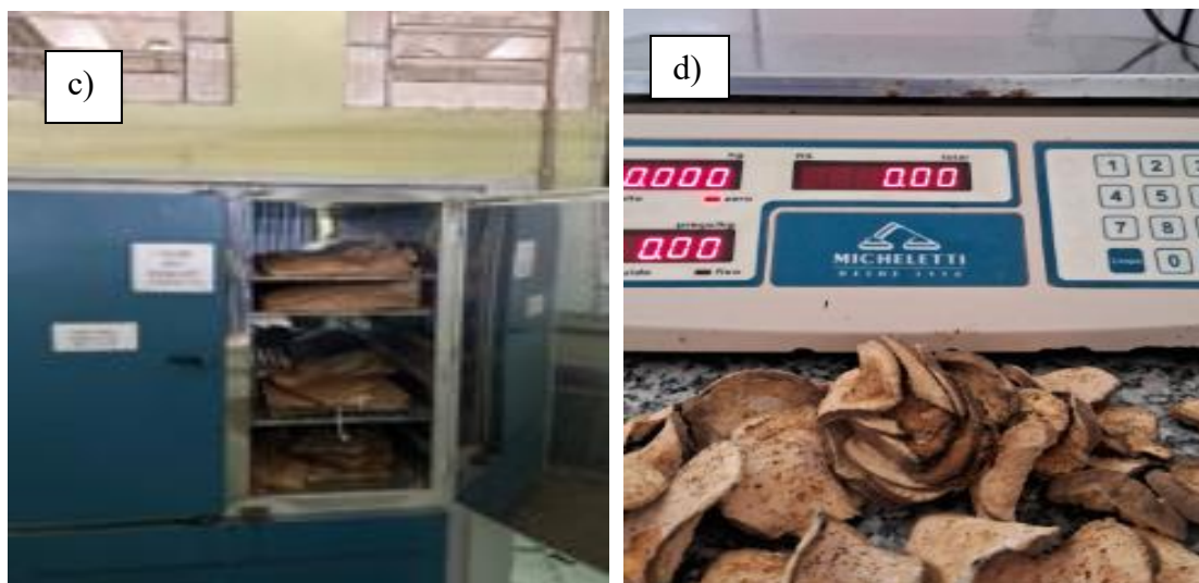
Figura 4: a) Corte e fatiada da raiz. b) Pesagem da massa úmida. c) estufa a 65°C d) pesagem massa seca.
