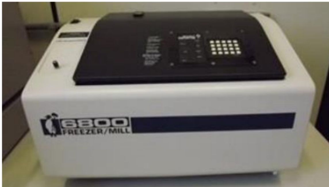
Figura 9 – Moedor criogênico Spex Certiprep 6800 Freezer/Mill.
