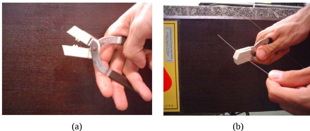
Figura 5.1 – Procedimento para remoção do revestimento. (a) Alicate de decapagem; (b) Retirada do revestimento.
