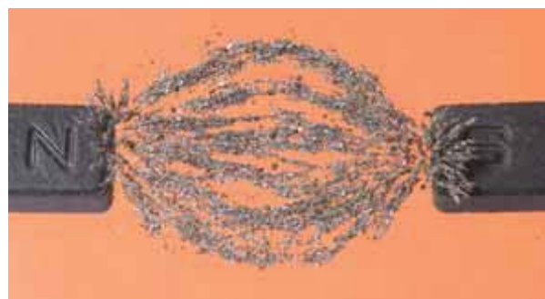
Figura 25. Visualização de campo magnético de dois ímãs com polos diferentes utilizando limalha de ferro.
