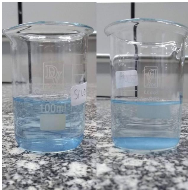
Figura 22 – Amostras do efluente, após 24 horas de reação, sem e com a suspensão da levedura, respectivamente
