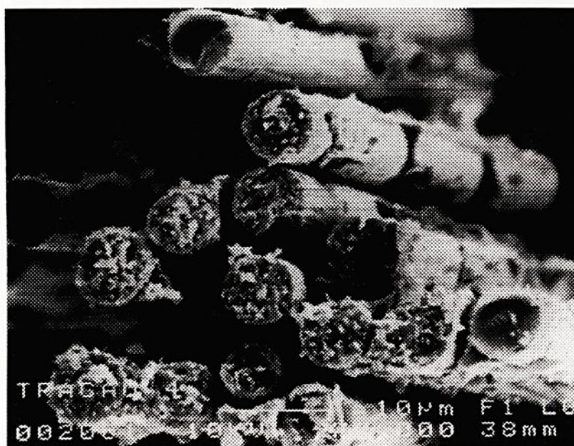
Figura 33 - Superfície de fratura do composto fibra de carbono/resina epoxi. CDP 4 (3000X).
