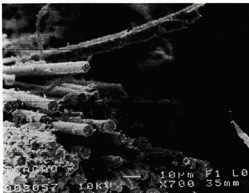
Figura 39 - Superfície de fratura do composto fibra de carbono/resina epoxi. CDP 7 (700X).
