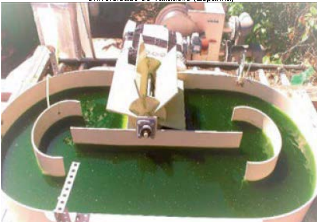
Figura 23 - Sistema de Cultivo de Algas em Lagoa Aberta do Tipo Raceway Pond da Universidade de Valladolid (Espanha)
