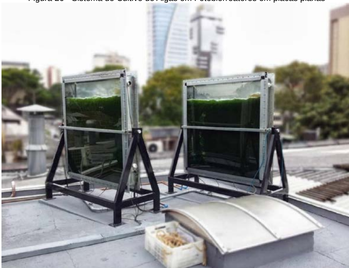
Figura 26 - Sistema de Cultivo de Algas em Fotobiorreatores em placas planas
