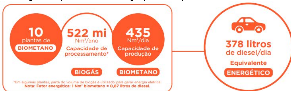
Figura 9 - Aproveitamento do Biogás para Produção de Combustível Veicular
