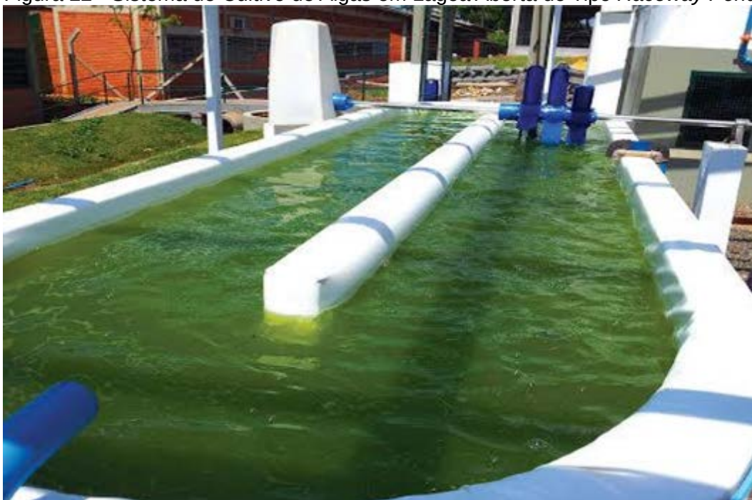
Figura 22 - Sistema de Cultivo de Algas em Lagoa Aberta do Tipo Raceway Pond
