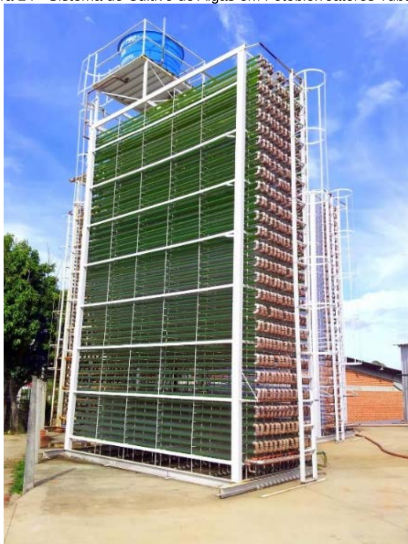
Figura 24 - Sistema de Cultivo de Algas em Fotobiorreatores Tubulares
