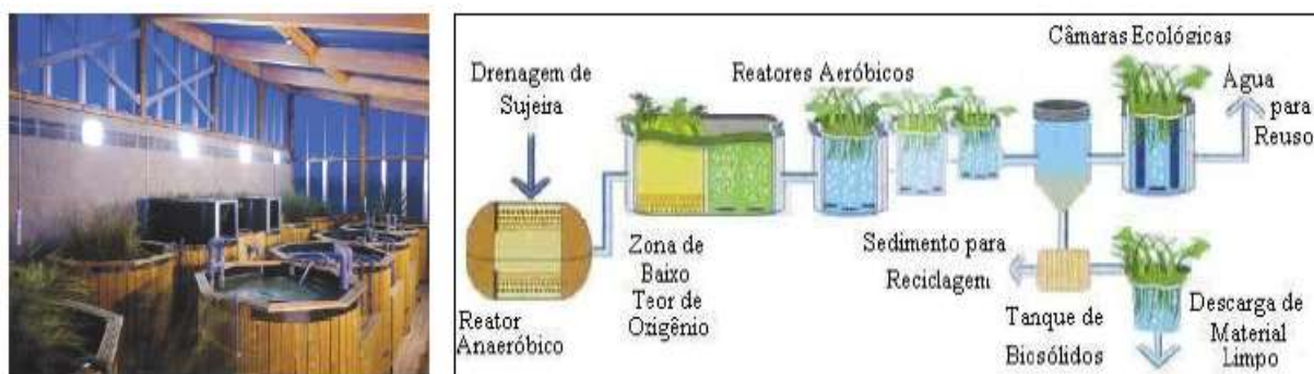
Figura 13 - Sistema de tratamento de esgoto
