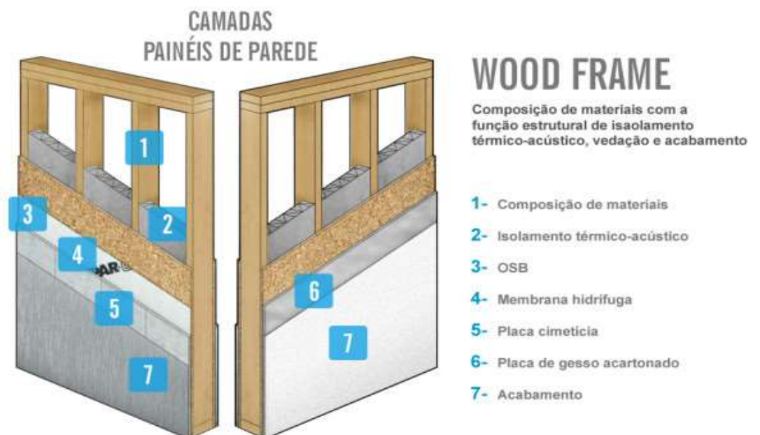
Figura 30 - Camada do painel wood frame
