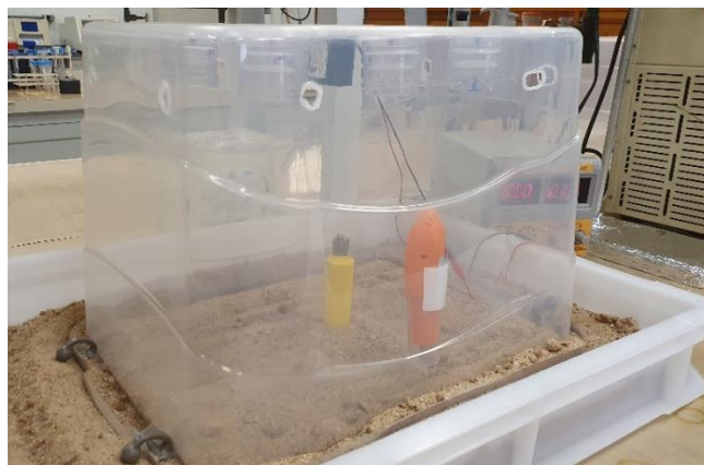
Figura 31. Câmara semi-aberta instalada sobre uma porção de areia. O tubo de permeação foi posicionado ao centro da câmara e o ventilador, ao fundo da caixa, próximo aos amostradores passivos. O termo-higrômetro permaneceu dentro da câmara durante a amostragem.
