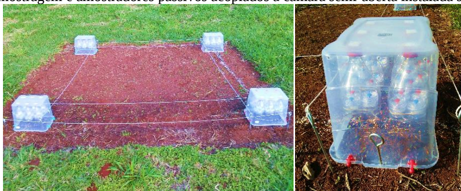
Figura 28. Fotografias do estudo piloto. Da esquerda para a direita: visão geral da área experimental durante a amostragem e amostradores passivos acoplados à câmara semi-aberta instalada sobre o solo.
