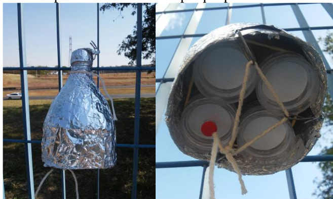
Figura 8. Conjunto de amostradores passivos acondicionados em garrafa PET e instalados no local de amostragem. Destaque à direita para o branco de campo que permanece fechado durante a amostragem.
