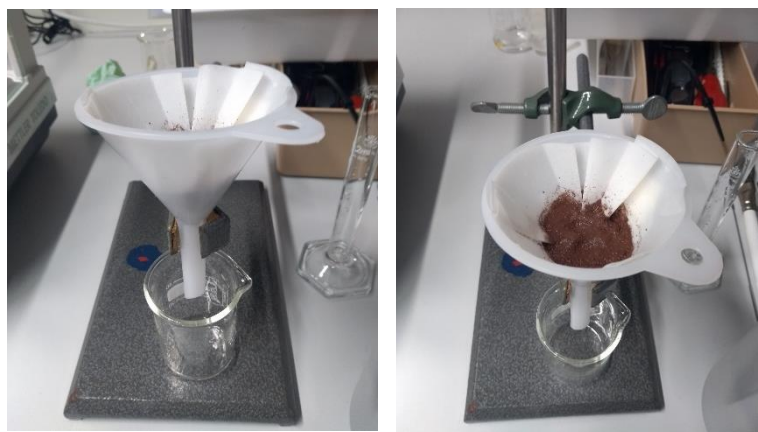
Figura 66. Aparato utilizado para determinação da Capacidade de Retenção de Água (CRA) das amostras de solo.
