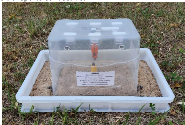
Figura 38. Aparato empregado na etapa de calibração da câmara semi-aberta instalado ao ar livre para avaliação da influência do transporte convectivo.
