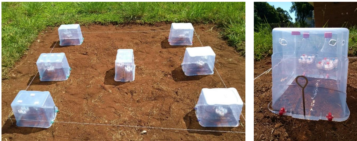
Figura 43. Câmaras semi-abertas acopladas aos amostradores passivos para \text{NH}_3 e \text{NO}_2 instaladas na região experimental do estudo.
