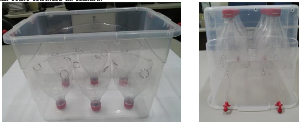
Figura 26. Fotografias da etapa de fixação dos porta-amostradores no fundo das caixas plásticas, que serviram como estrutura da câmara.
