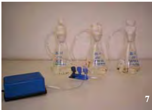
Figuras: 1 - Placas de Petri de 60 e 100 mm; 2 - Tubos de 100 e 200 mm; 3 - Placa de Kline (“pescaria”); 4 - Inóculo na Câmara de Fluxo; 5 - Placas e tubos na incubadora; 6-7 - Sistema de aeração forçada (fotobiorreator fechado): 1. Motor; 2. Cano delgado principal com algodão como filtro; 3. Regulador de aeração; 4. Canos delgados para aeração individual; 5. Erlenmeyers de 250 mL. (adaptado de REICHERT et al. , 2006); 8 - Erlenmeyers no shaker.
