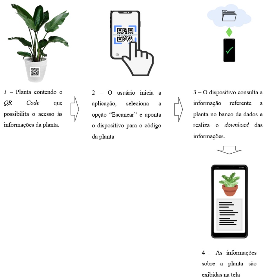
Figura 17 - Diagrama esquemático representando o funcionamento do aplicativo
