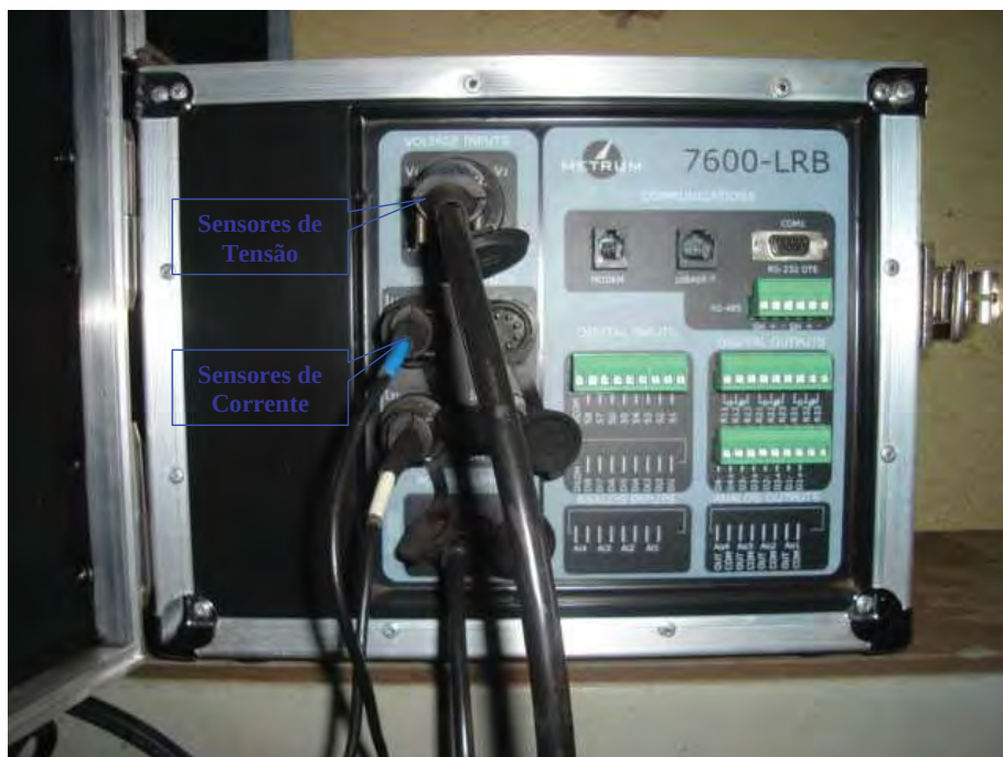
Figura 3.8. Detalhe da Entrada dos Sensores de Tensão e de Corrente no Qualímetro.
