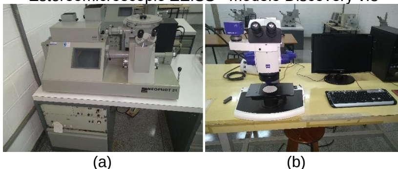
Figura 200 – a) Microscópio óptico, marca: ZEISS, modelo Neophot 21; b) Estereomicroscópio ZEISS - modelo Discovery v.8
