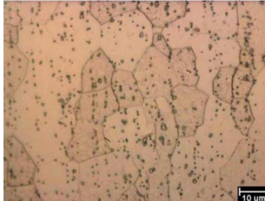
Figura 9 – Microestrutura de um aço inoxidável ferrítico. Grãos cristalizados de ferrita com carbonetos de cromo. Ataque químico Vilella
