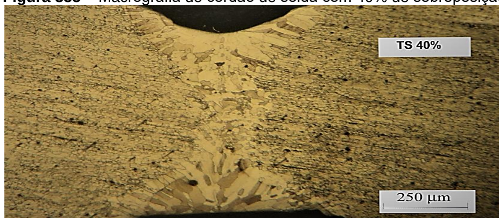
Figura 355 – Macrografia do cordão de solda com 40% de sobreposição
