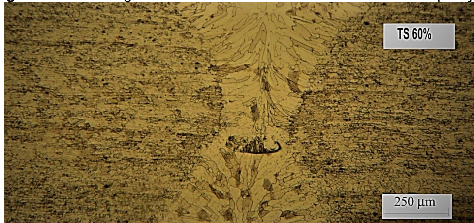
Figura 33 – Macrografia do cordão de solda com 60% de sobreposição
