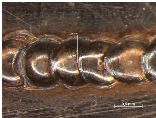
Figura 25 – Vista superior do cordão de solda
