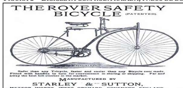
FIGURA 8 – BICICLETA COM RODA RAIADA, PNEUS DE BORRACHA E FREIOS
