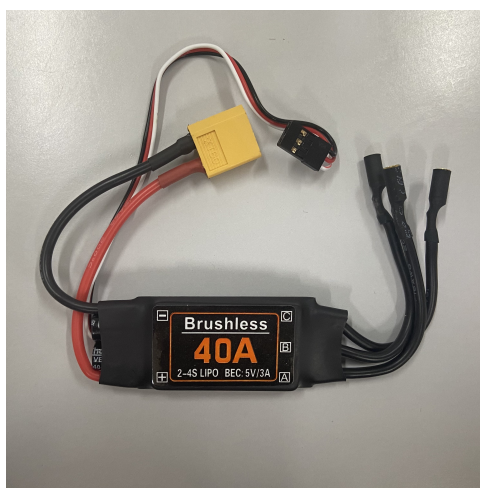
Figura 45 – ESC de 40A com BEC integrado.
