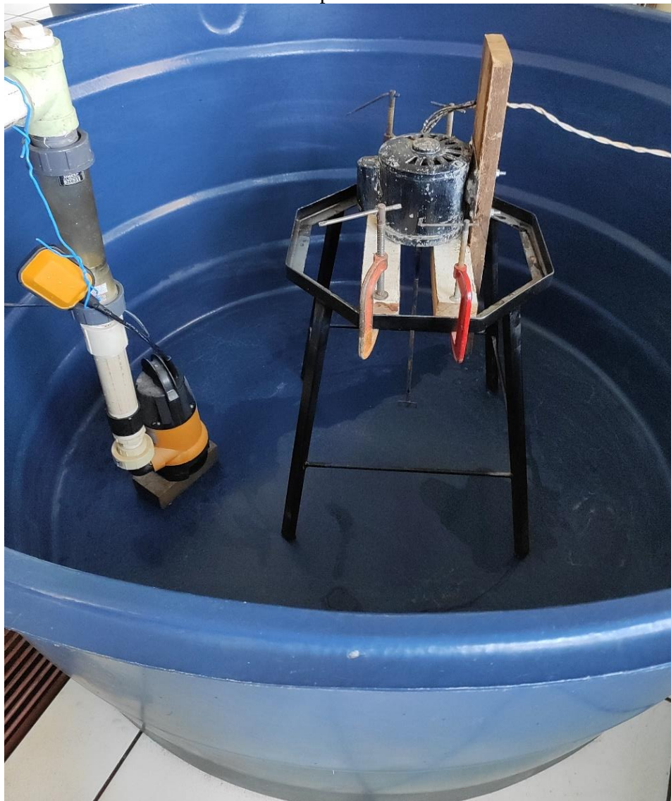
Figura 15 - Tanque de homogeneização utilizado para manutenção das partículas finas em suspensão.
