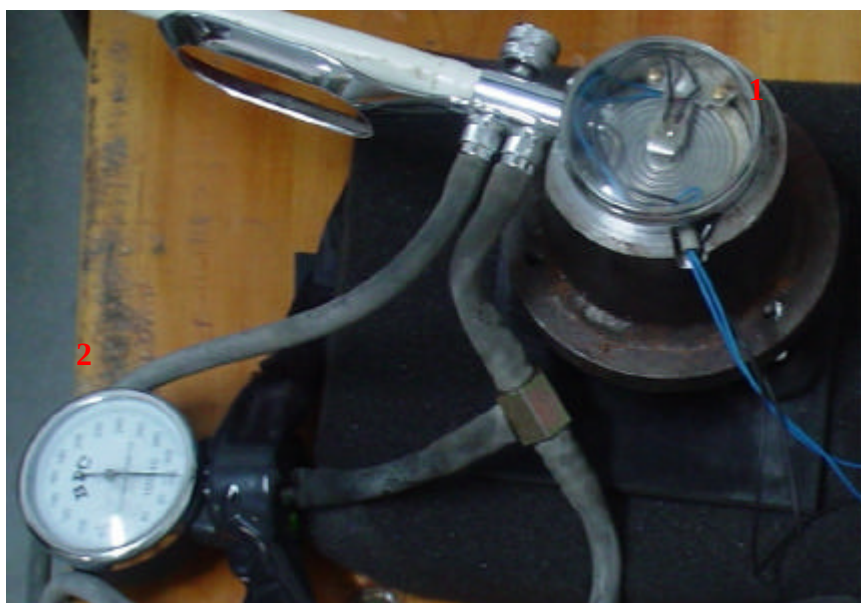
Figura 3.8 – Manômetros aneróides com leitura simultânea da pressão arterial. (1) leitura do extensômetro. (2) leitura convencional.
