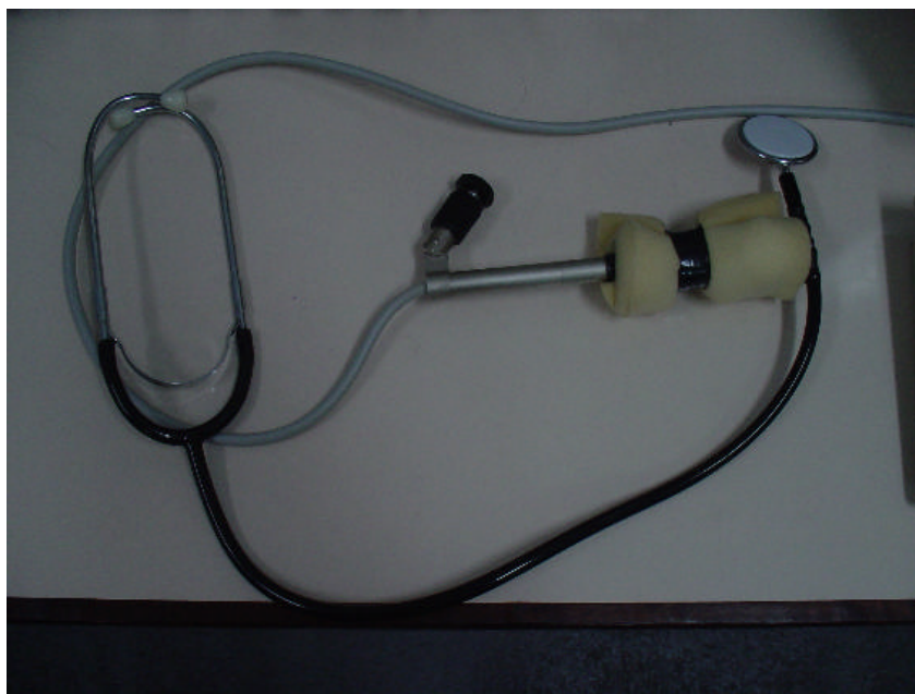
Figura 3.1 – Estetoscópio: microfone acoplado próximo à campânula e as olivas liberadas para a ausculta.
