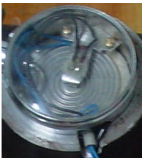
Figura 3.4 – Manômetro adaptado com o extensômetro
