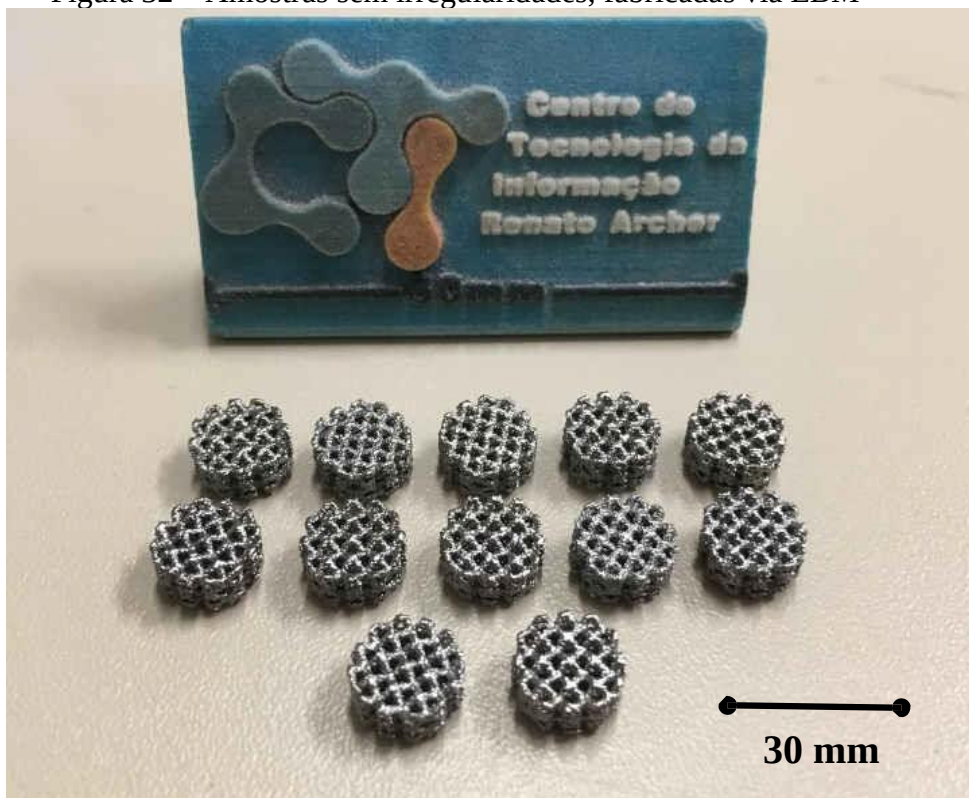
Figura 32 – Amostras sem irregularidades, fabricadas via EBM
