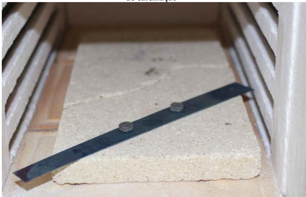
Figura 30 – Amostras sobre uma placa de Ti, inseridas no forno mufla EDG para o processo de calcinação
