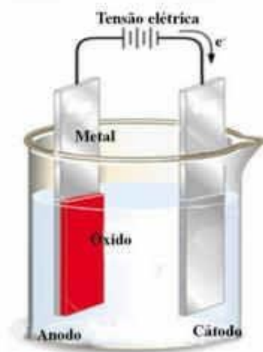
Figura 17 – Representação de uma célula utilizada para a oxidação anódica
