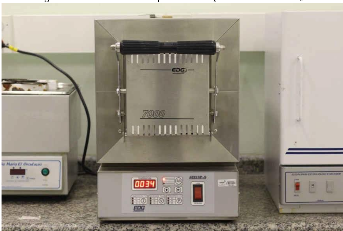
Figura 29 – Forno mufla EDG para cristalização da camada de \text{TiO}_2
