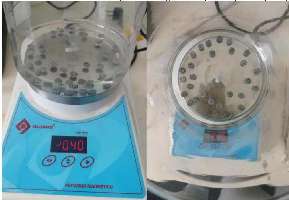
Figura 27 – Amostras imersas na solução sob um agitador magnético para limpeza química
