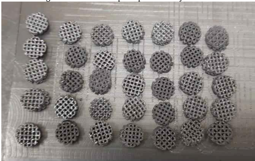
Figura 26 – Amostras após o processo de jateamento
