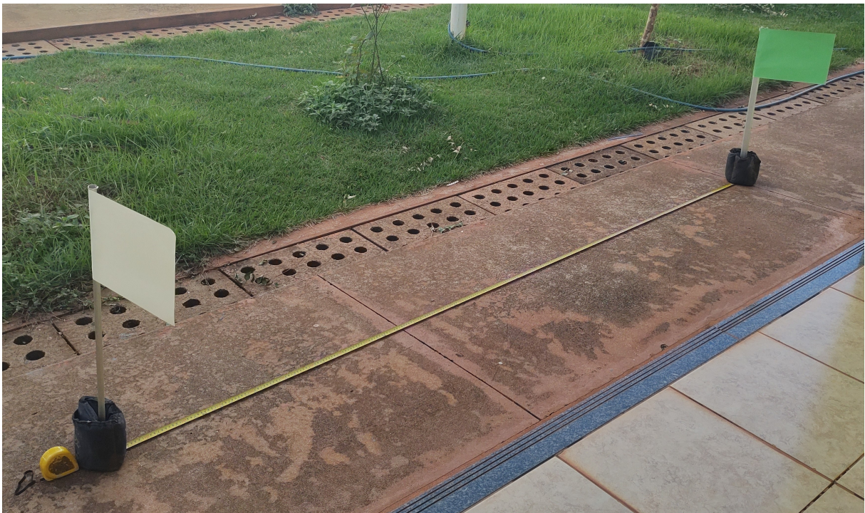
Figura 48 – Amostra de marcação realizada para a realização dos testes sobre textura áspera em cimento.
