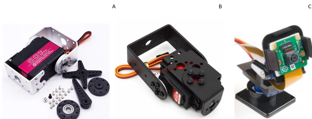
Figura 25 – Artefatos utilizados na construção da estrutura física do protótipo 2 integrados ao servo. A) dobradiça e extensão para servo de 60 kgf.cm e de 80 kgf.cm; B) dobradiça e extensão para servo de 20 kgf.cm, 30 kgf.cm e 40 kgf.cm; C) Módulo pan/tilt com 2 micro servos 9g SG90.
