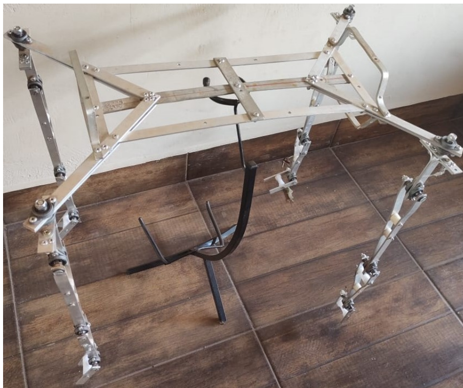
Figura 15 – Estrutura física do esqueleto do dispositivo referente ao protótipo 1 confeccionada em alumínio.
