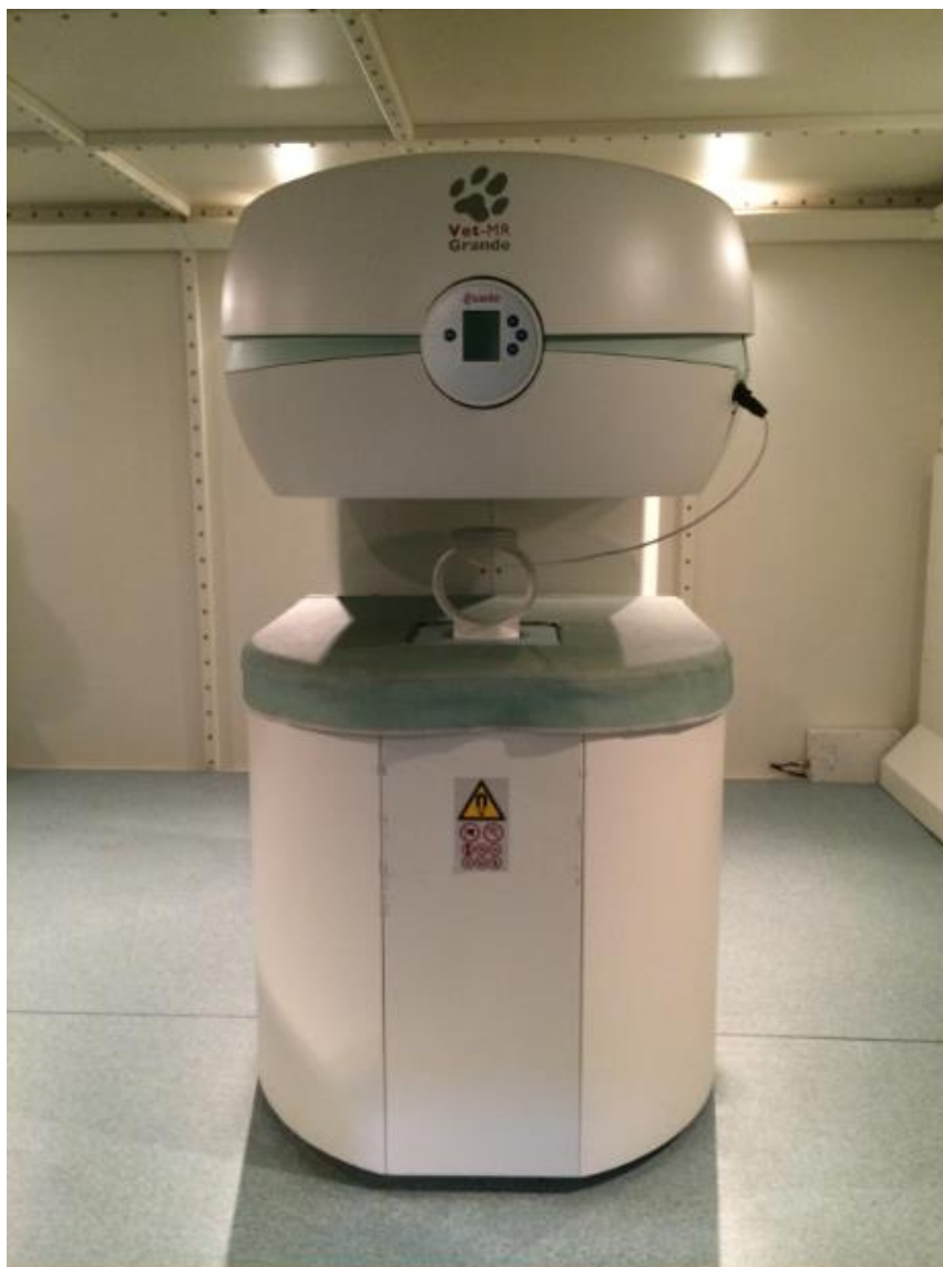
Figura 1. Aparelho de Ressonância Magnética ESAOTE 0.25 T Vet-MR GRANDE e bobina C-shaped coil . Foto: Arquivo pessoal
