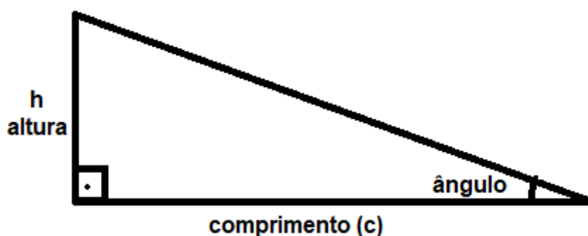
Figura 28: Cálculos para uma rampa segundo ABNT NBR 9050.
