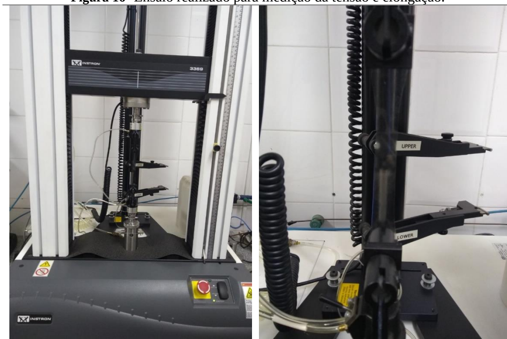
Figura 16- Ensaio realizado para medição da tensão e elongação.
