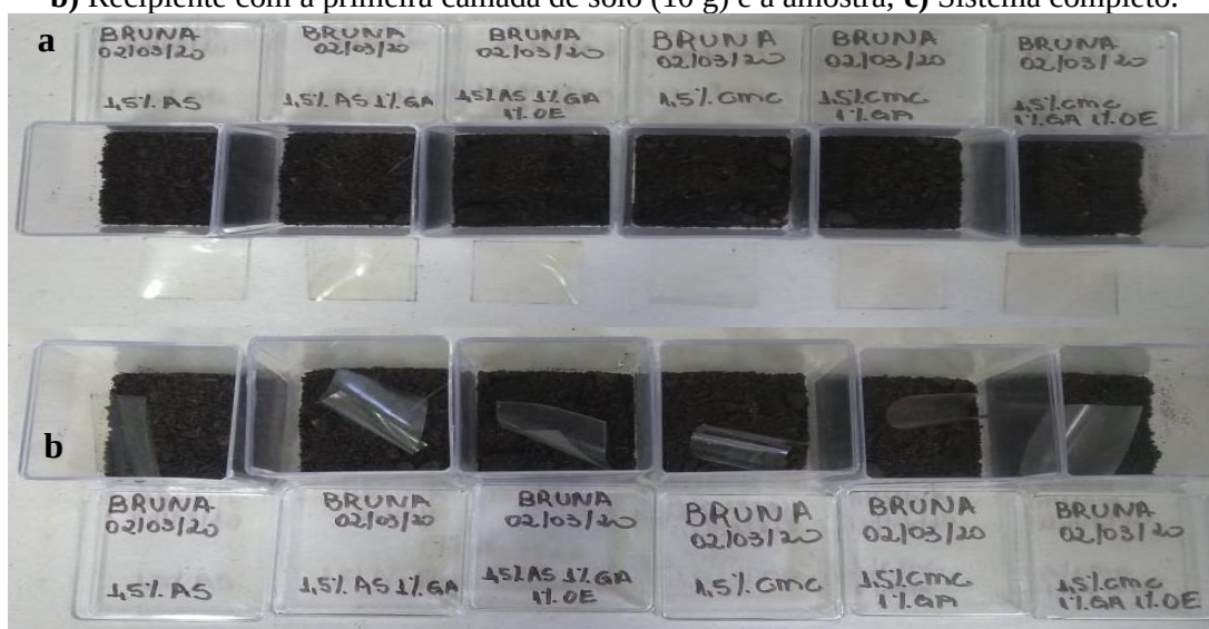
Figura 19- Sistema 1 com a amostra enterrado. a) Recipiente com a primeira camada de solo (10 g); b) Recipiente com a primeira camada de solo (10 g) e a amostra; c) Sistema completo.
