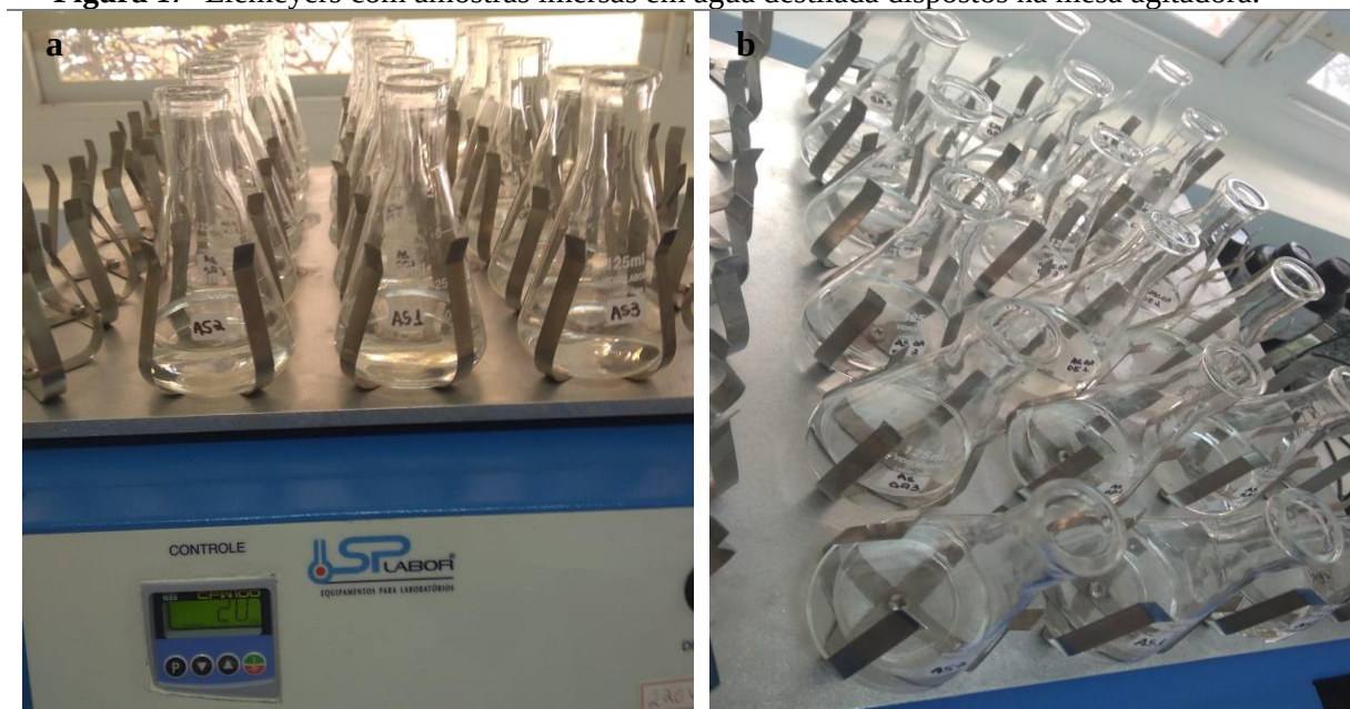
Figura 17- Elemeyers com amostras imersas em água destilada dispostos na mesa agitadora.
