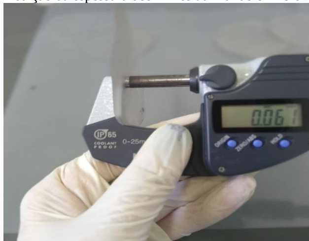
Figura 10- Medição da espessura dos filmes utilizando o micrômetro digital.
