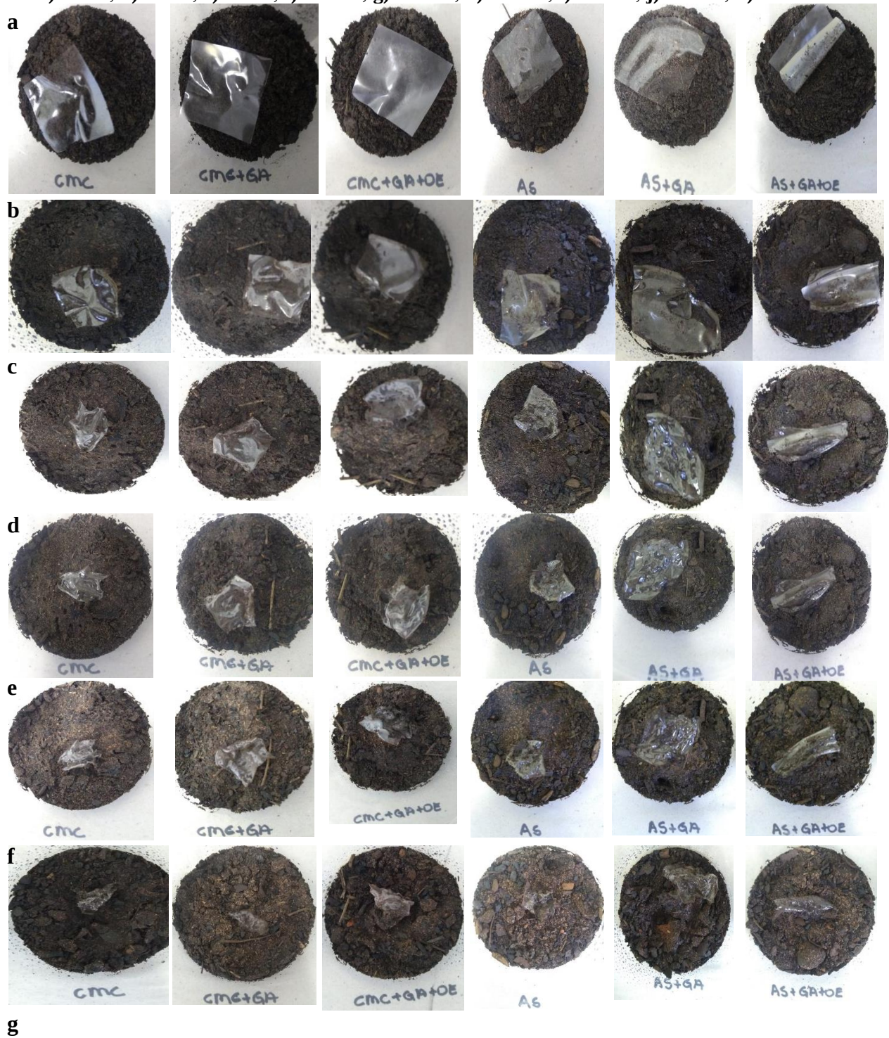
Figura 35 – Teste de biodegradabilidade com as amostras expostas sobre o solo. a) 0 dia; b) 1 dia; c) 2 dias; d) 3 dias; e) 5 dias; f) 16 dias; g) 23 dias; h) 35 dias; i) 42 dias; j) 51 dias; k) 67 dias.
