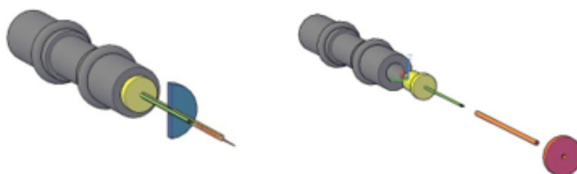
Figura 9 - (a) Esquema de encaixe entre os componentes do dispositivo de microjato em 3D; (b) vista explodida
