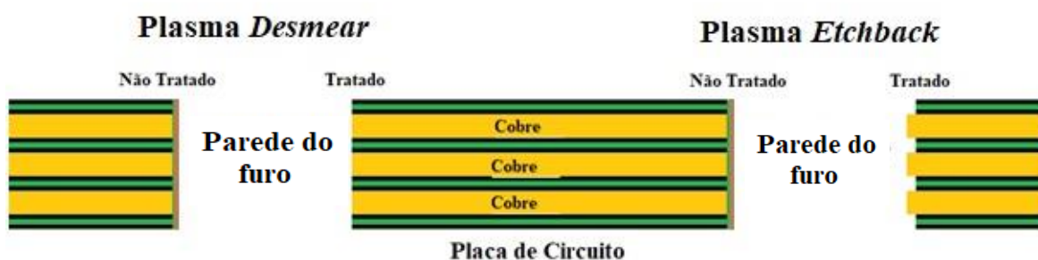
Figura 5 - Comparação entre os processos de plasma desmear e plasma etchback
