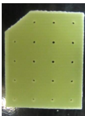
Figura 21 - Exemplo de amostra utilizada para ensaios em furos passantes
