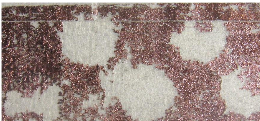
Figura 33 - Resultado obtido pela remoção da fita adesiva de uma amostra tratada em pontos não alinhados
