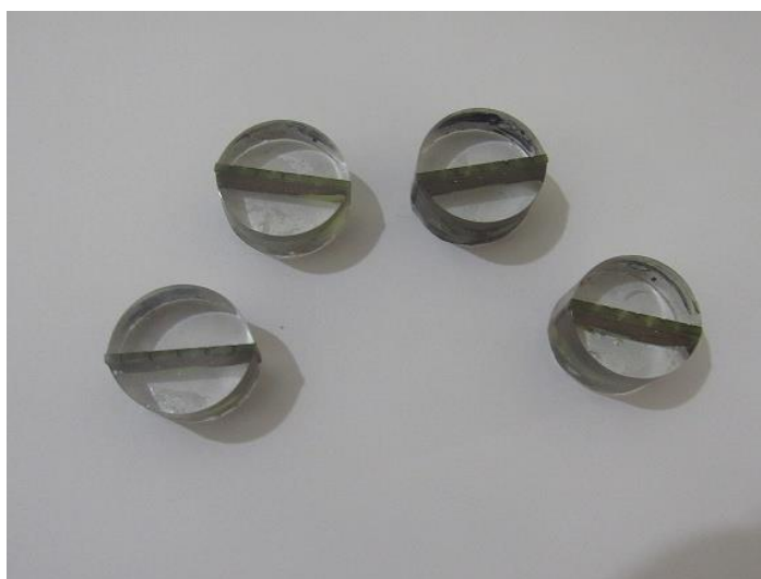
Figura 23 - Exemplo de amostras de furo metalizado embutidas
