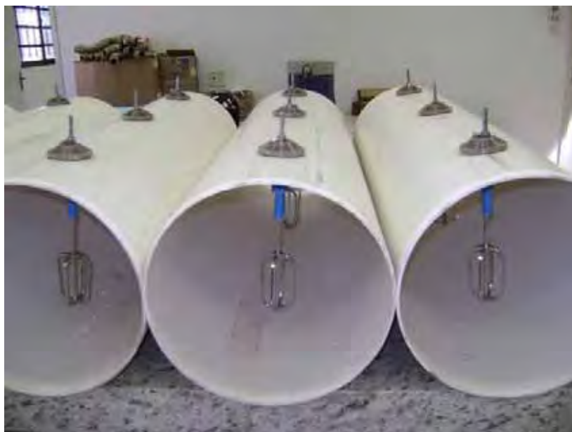
Figura 5. Sistema de agitação dos biodigestores contínuos.
