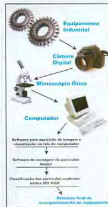
Figura 3. Fluxograma do processo da contagem e classificação das partículas.
