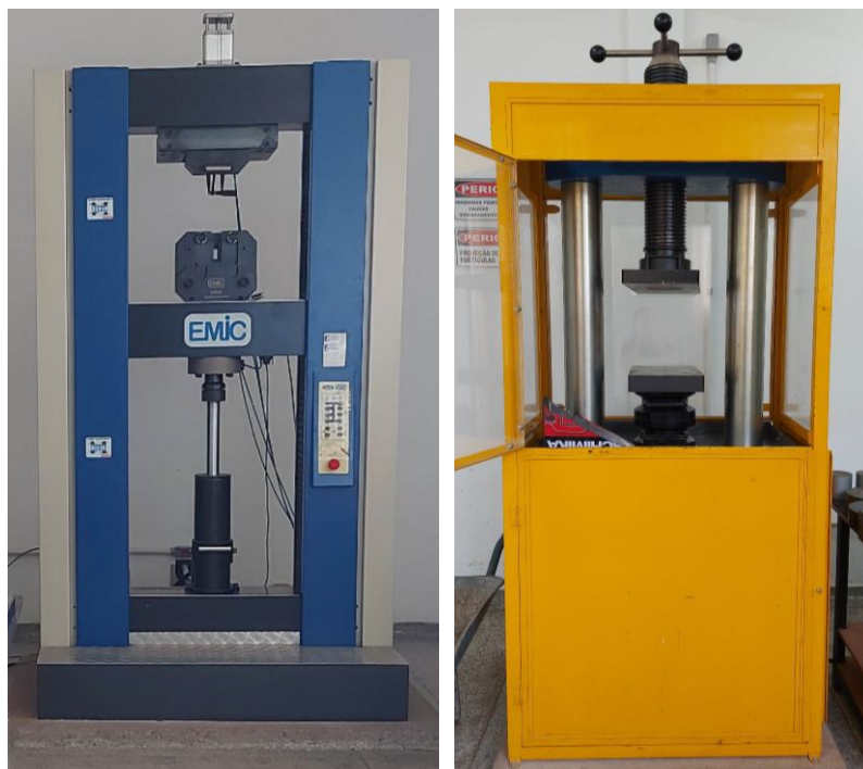
Figura 7 – Detalhe da máquina universal de ensaios da EMIC – INSTRON
