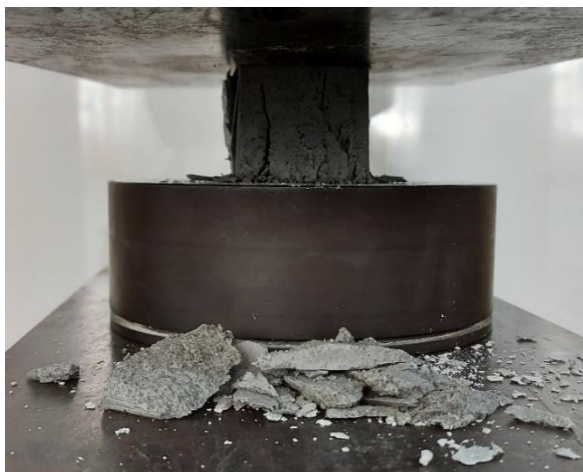
Figura 8 – Realização do ensaio de resistência à compressão em CP contendo sílica ativa
