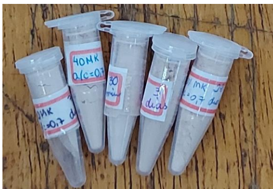
Figura 6 – Amostras das pastas em pó para ensaios microestruturais
