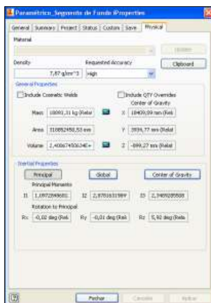
Figura 44 - Massa do modelo da comporta segmento de fundo.
