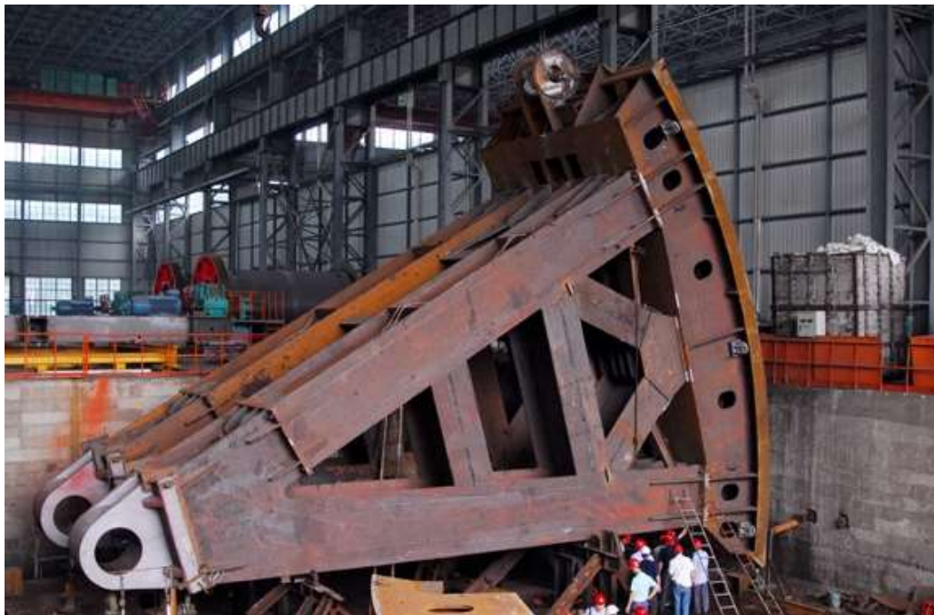
Figura 8 - Estrutura de uma comporta segmento de fundo.
