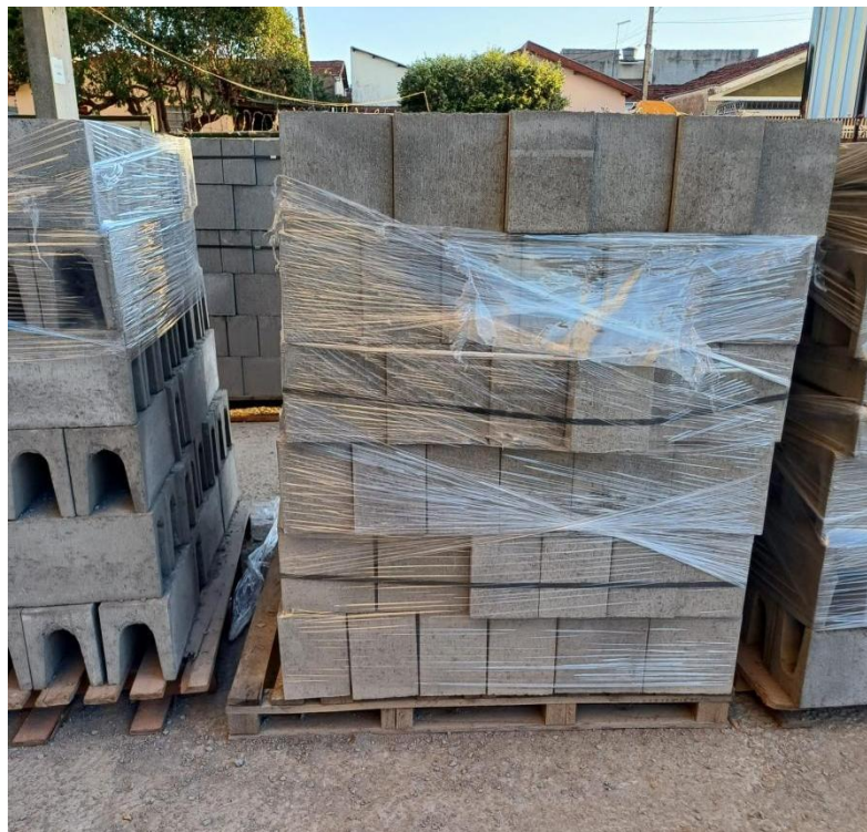
Figura 35 – Bloco de 4,5 MPa
