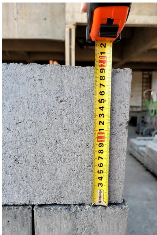
Figura 42 – Altura de um bloco de concreto
