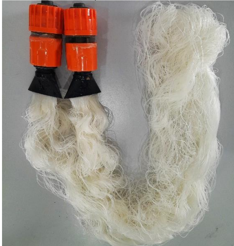
Figura 15 - Membrana disposta no tubo interno do MABR
