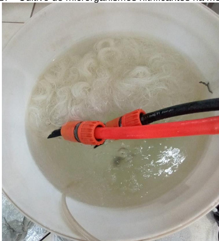
Figura 17 - Cultivo de microrganismos nitrificantes na membrana
