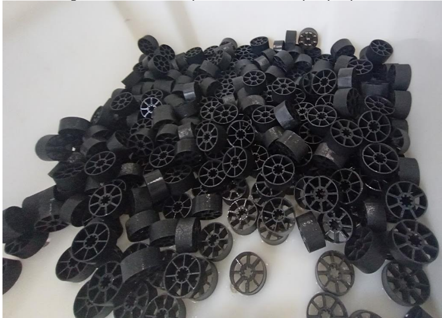
Figura 12 - Meio suporte: mídia de polipropileno
