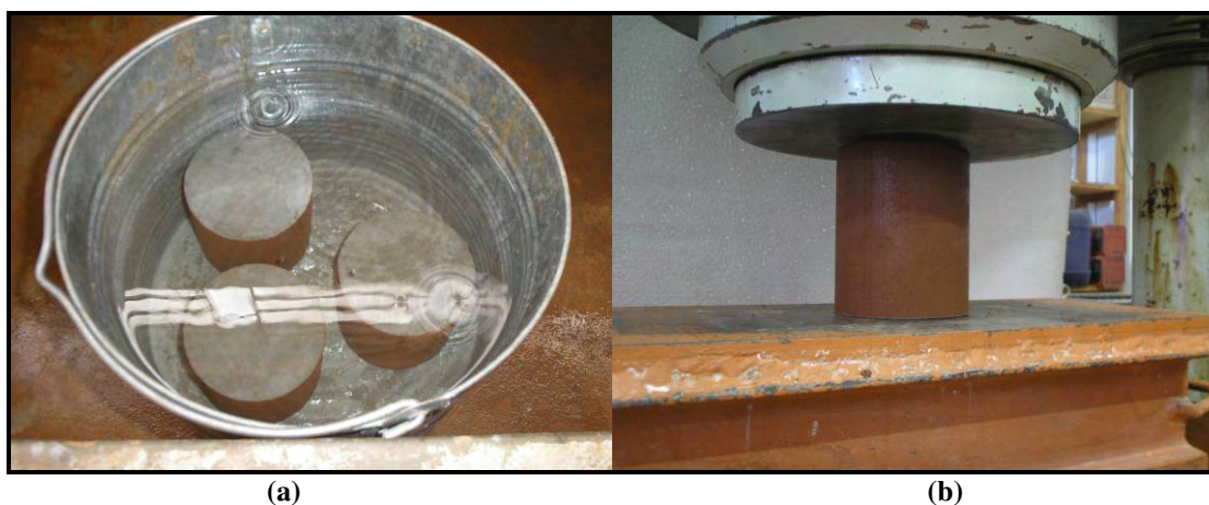
Figura 5.12: Corpos-de-prova em imersão (a) e prestes a ser carregado axialmente (b).
