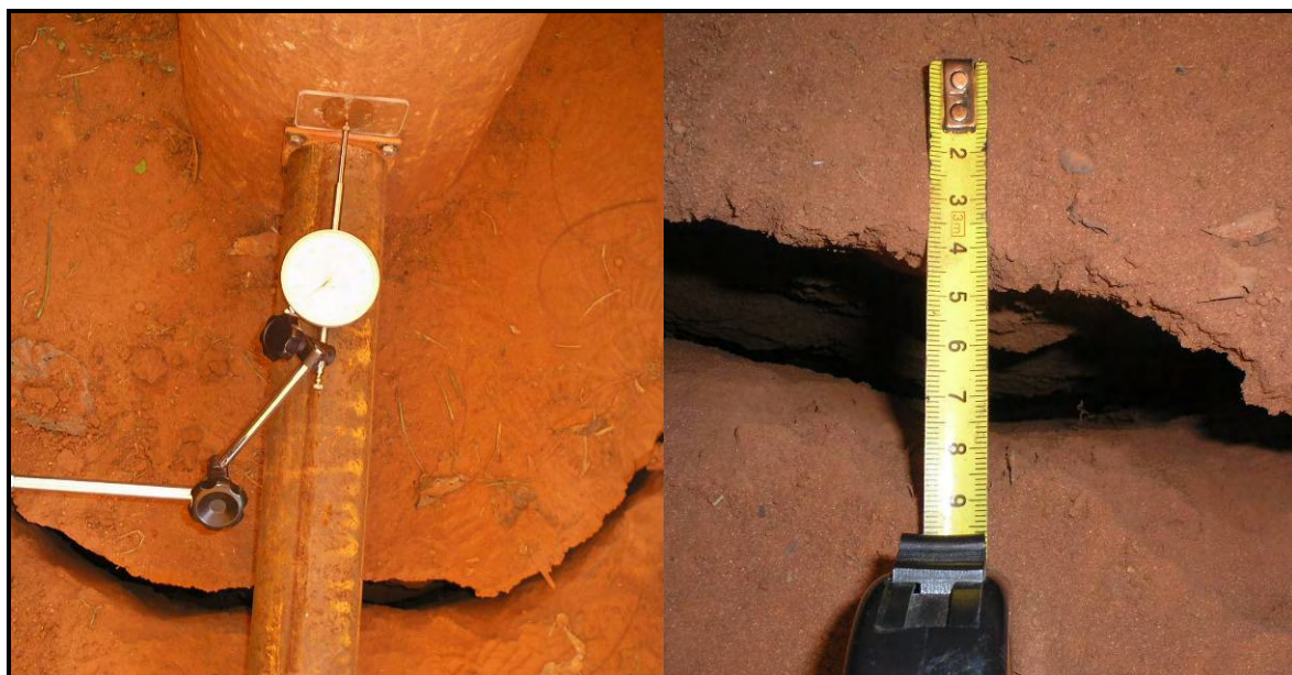
Figura 7.11: Abertura entre o bloco e o solo natural para o último estágio de carregamento (carga de 128 kN, y_i=37,88 mm).
