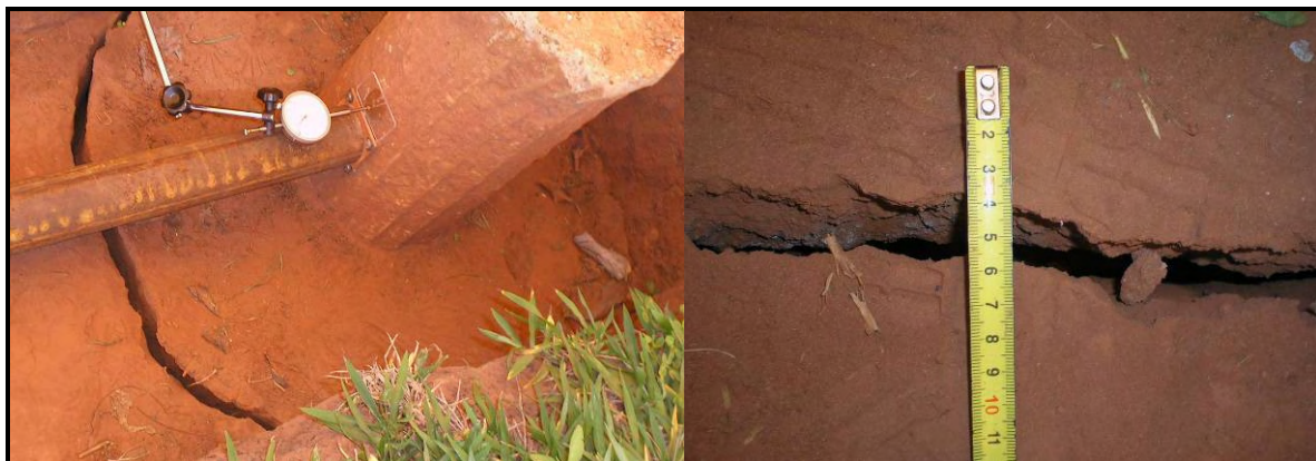
Figura 7.10: Abertura entre o bloco e o solo natural no 28º estágio de carregamento (carga de 112 kN, 89% da carga máxima aplicada, y_i=25,30 mm).
