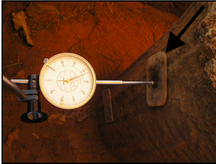
Figura 6.13: Relógio comparador e placa de acrílico (sinalizada pela seta).
