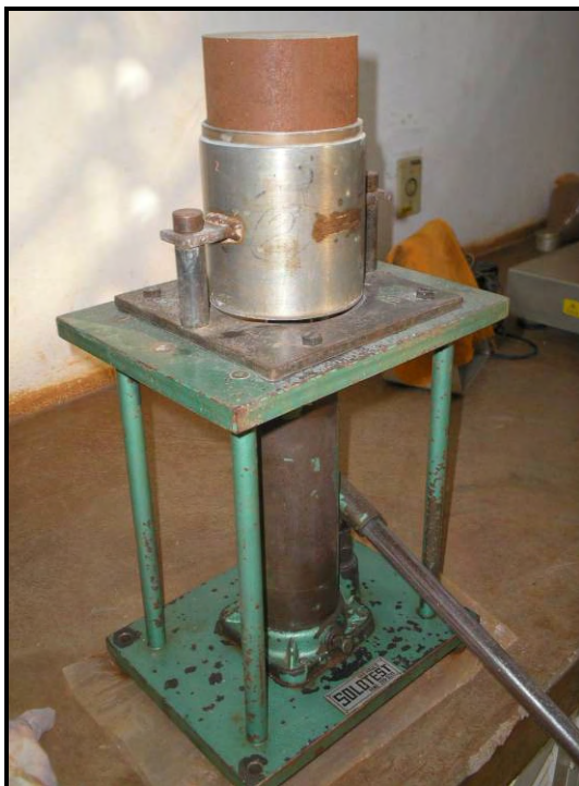
Figura 5.10: Corpo-de-prova de solo-cimento sendo desmoldado.
