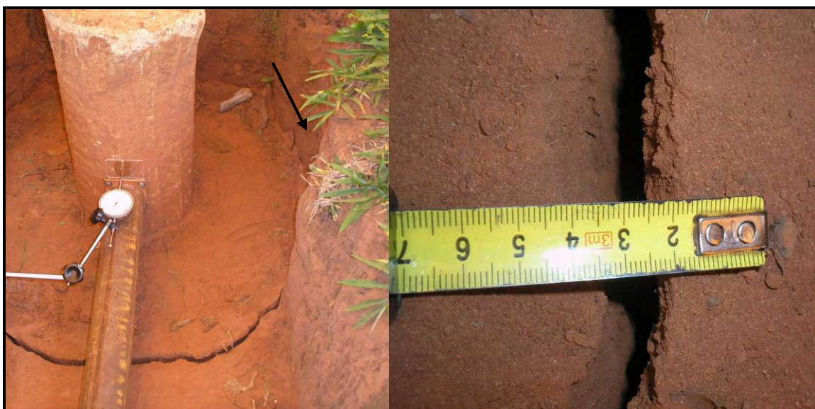
Figura 7.9: Abertura entre o bloco e o solo natural no 22° estágio de carregamento (carga de 88 kN, 69% da carga máxima aplicada, y_t=10,80 mm).
