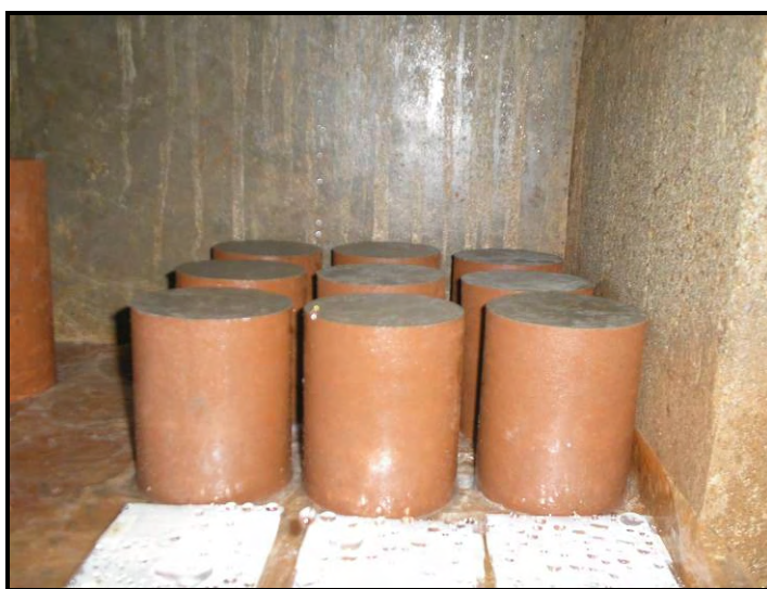
Figura 5.11: Corpos-de-prova submetidos à cura em câmara úmida.
