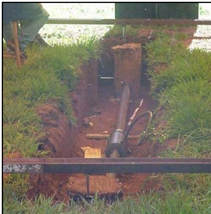
Figura 6.8: Estacas teste quando ensaiadas por Del Pino Jr. (2003).
