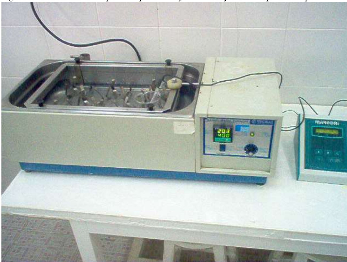
Figura 1 - Sistema utilizado para adequar a solução às condições de temperatura e pH.
