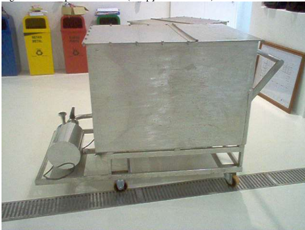
Figura 12 - Tanque com bomba (recepção do leite cru).
