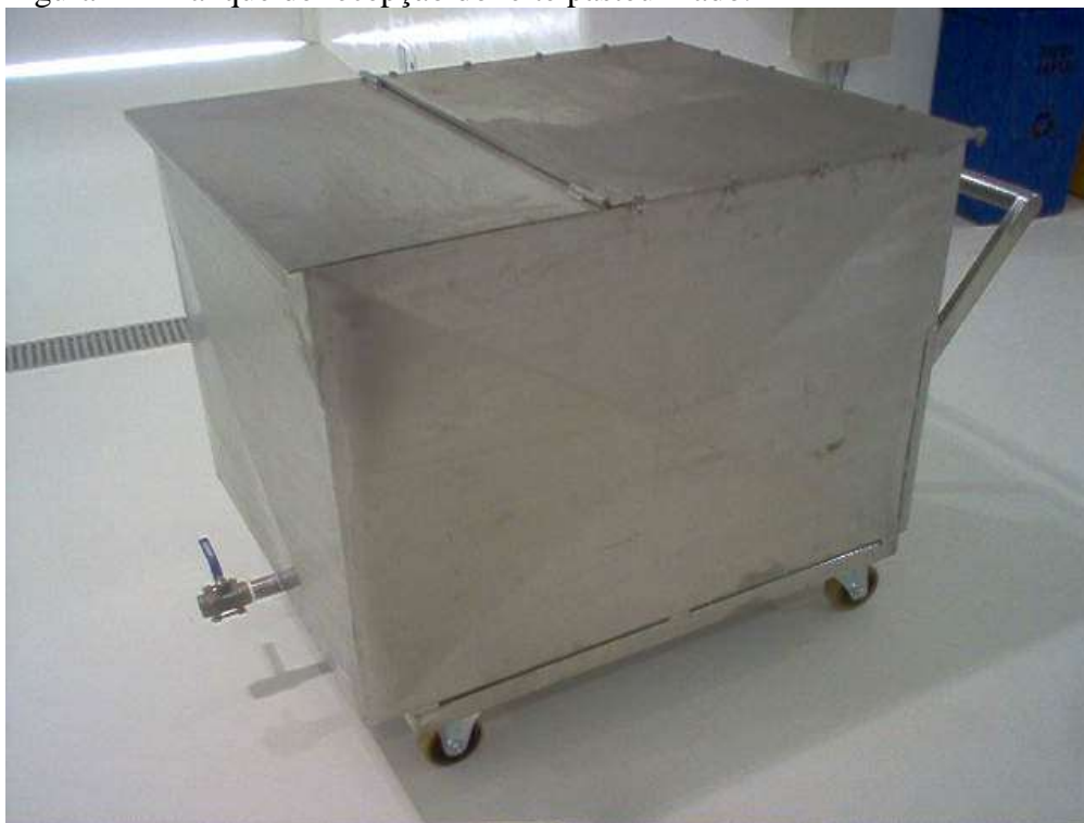
Figura 14 - Tanque de recepção do leite pasteurizado.
