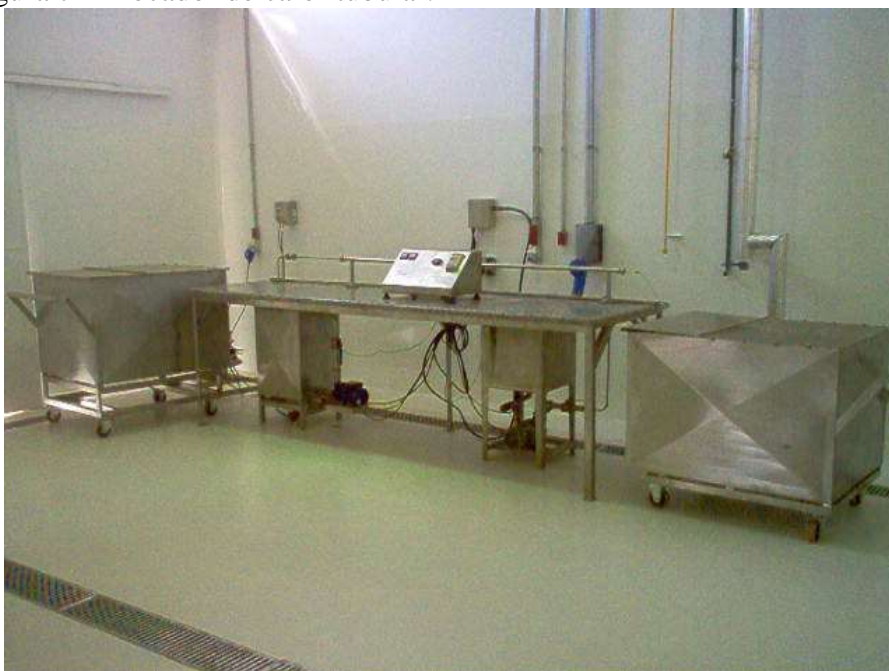
Figura 7 - Trocador de calor tubular.
