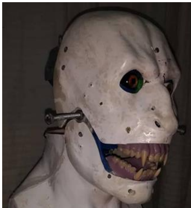
Figura 54: Acoplagem de eixo de impressora na junta da mandíbula.
