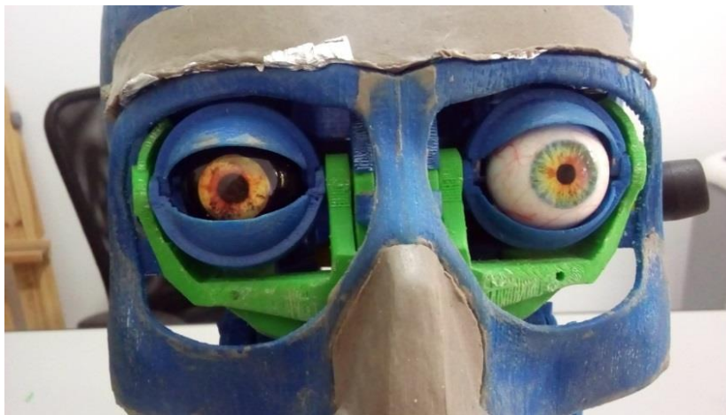
Figura 37: Acoplagem final dos olhos na estrutura.
