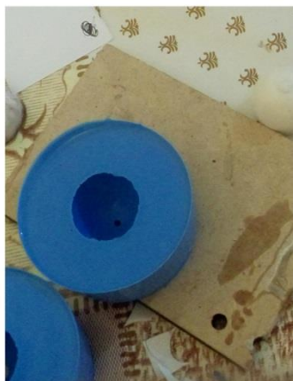
Figura 32: Resultado final do molde do olho em negativo.
