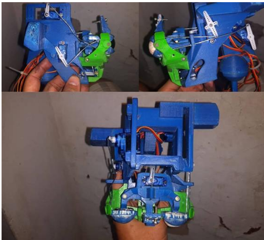
Figura 55: Acoplagem das hastes dos cliques nos atuadores da estrutura.
