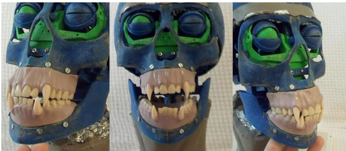
Figura 10: Resultado final da prótese já acoplada na estrutura
