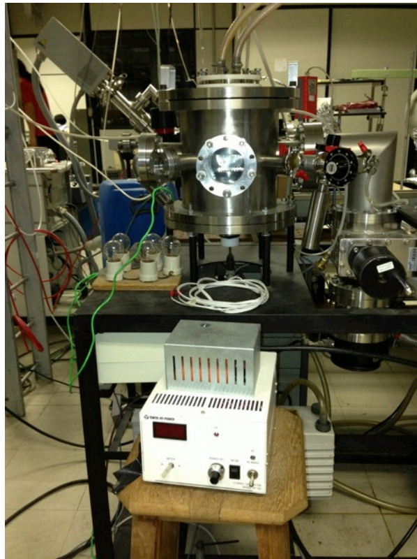
Figura 17 - Equipamento empregado para a deposição do filme de HMDSO.
