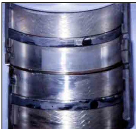
Figura 2.13 – Par de conchas de mancal mostrando região lisa nos lados opostos das conchas ( Failure Investigation , www.tribology.co.uk ).
