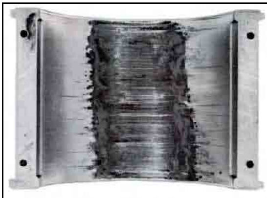
Figura 2.11 – Dano por “fretting” em um mancal causado por vibração ( Failure Investigation , www.tribology.co.uk ).
