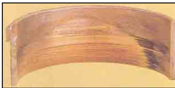
Figura 2.5 – Bronzina danificada por desgaste (MAHLE, 2003).
