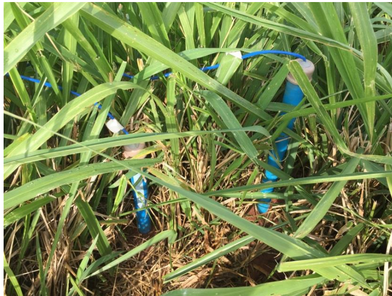
Figura 31 - Parcela com sensores de umidade de solo instalados a 0,20 cm de profundidade.
