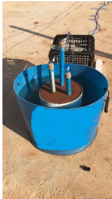
Figura 25 - Método de Pesagem (amostra saturada).
