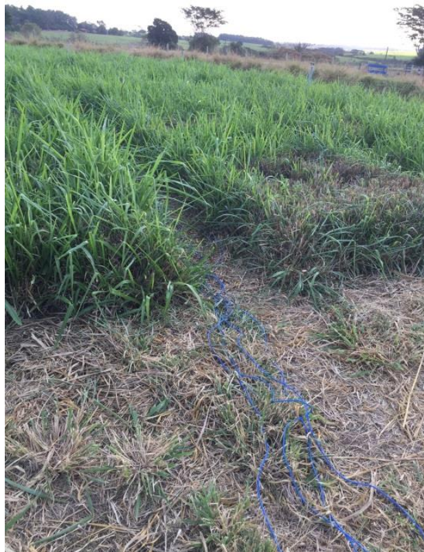
Figura 32 - Vista do direcionamento do cabeamento dos sensores de umidade de solo nas parcelas.
