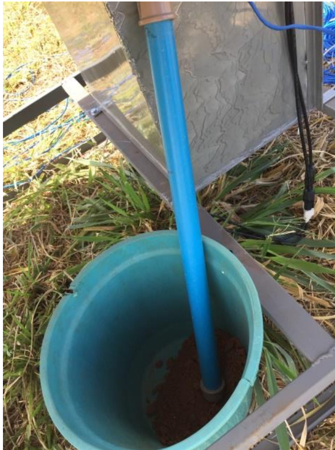
Figura 29 - Sensor de umidade no solo seco
