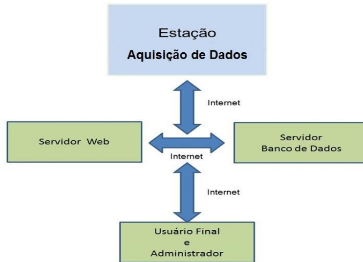
Figura 22 - Transmissão de dados e emissão de relatório de dados gerados pela Estação de Aquisição de Dados.
