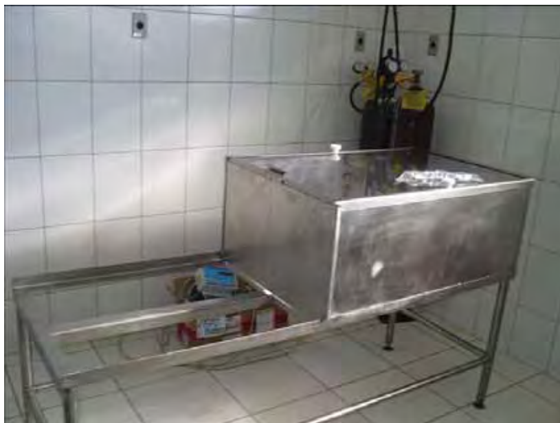
Foto 1 - Câmara de insensibilização em atmosfera controlada.
