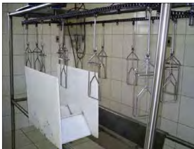
Foto 4 - Trilhagem com nórias para pendura dos frangos, equipamento de eletronarcose e calha de sangria.
