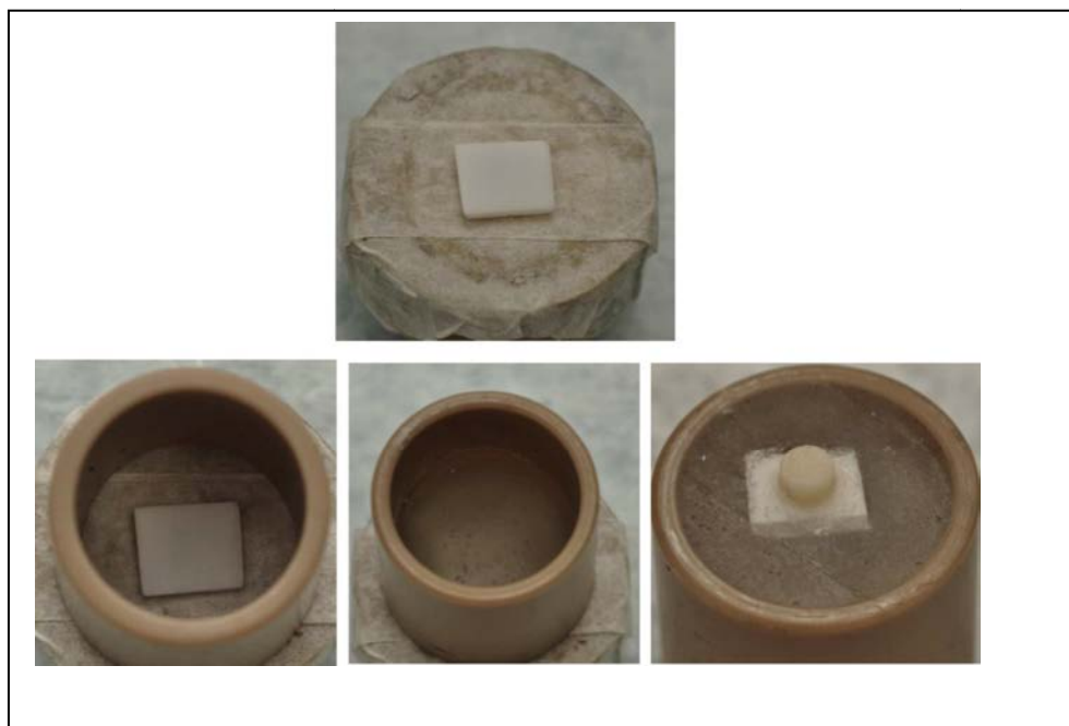
Figura 11 - Passos para embutimento dos corpos de prova na resina acrílica e anel de PVC de meia polegada.
