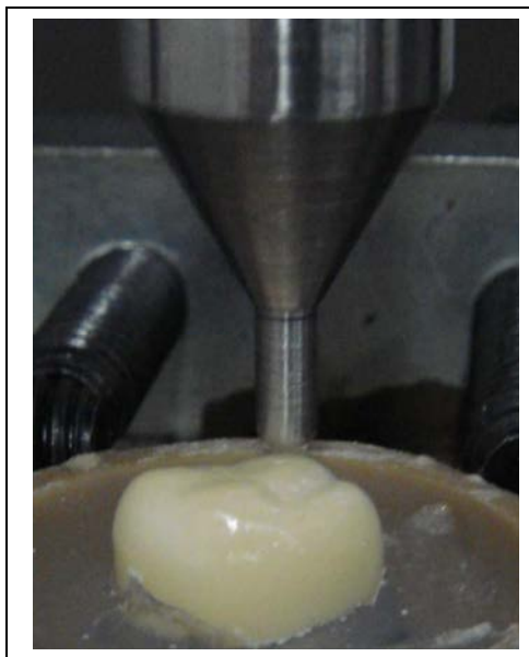
Figura 6 - Corpo de prova posicionado na ponta semi-esférica de 3 mm de diâmetro, posicionada na cúspide mesio-palatina.
