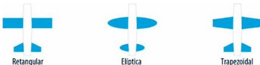
Figura 29 – Formas em planta de asas
