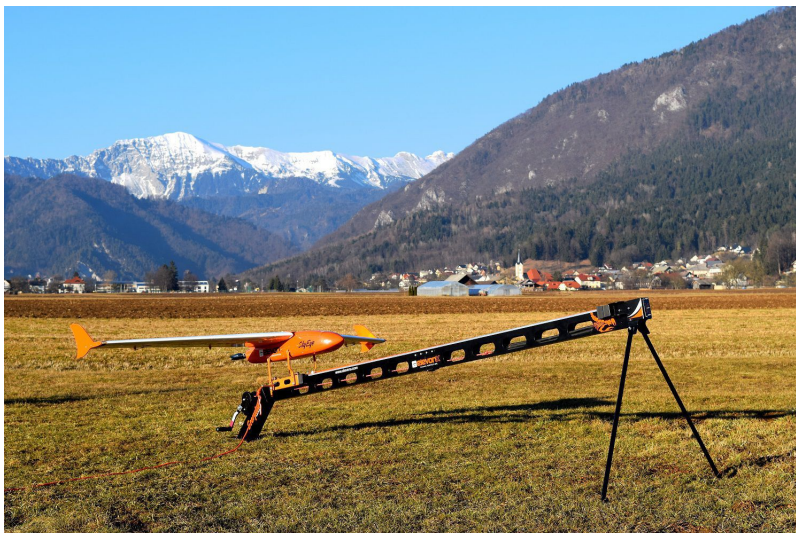
Figura 12 – Drone sendo lançado por sistema de catapulta.
