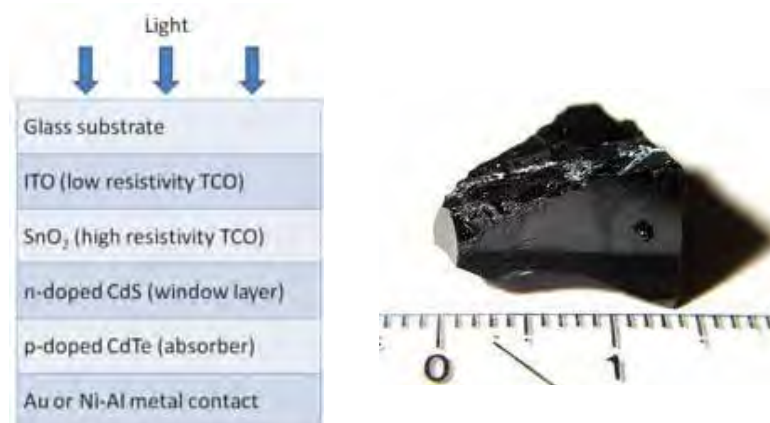
Figura 2.12: Célula de Telureto de Cádmio. À direita, estrutura das camadas componentes de uma célula. À esquerda, cristal de CdTe.
