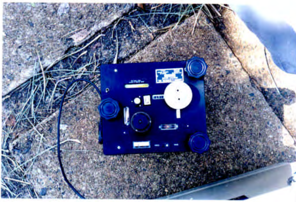
Foto 4.2 Gravímetro LaCoste & Romberg, empregado no levantamento gravimétrico.
