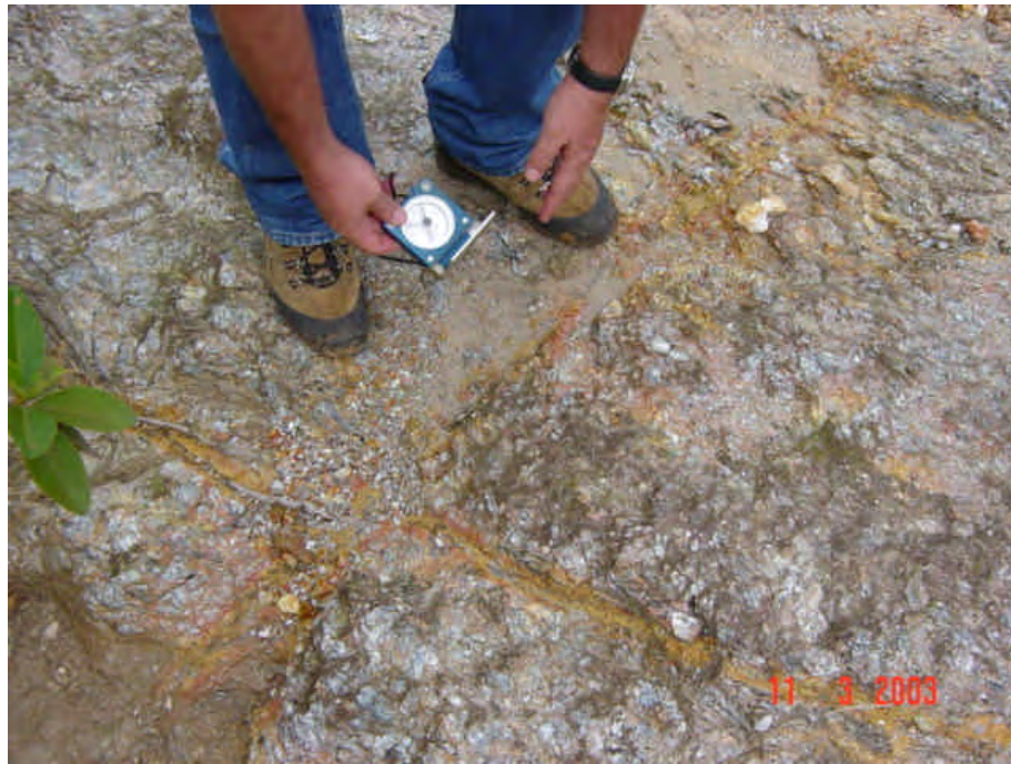
Foto 3.13 Mica sericita xistos com intenso fraturamento. Estrada vicinal que atravessa a Serra Preta rumo a Serra da Canastra próximo ao Rio Santo Antônio.
