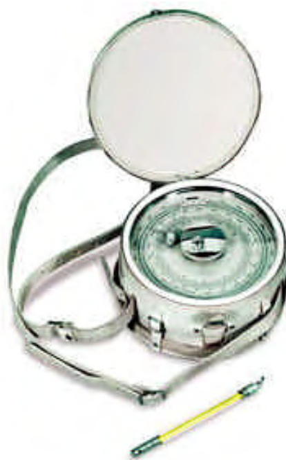
Foto 4.1 Altímetro da American Paulin System usado no levantamento de dados gravimétricos deste trabalho.
