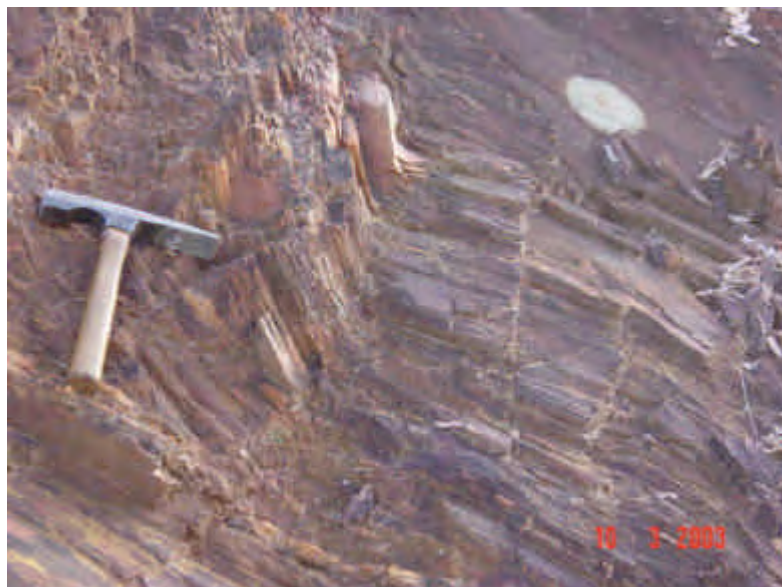
Foto 3.6 Mesmo afloramento. Notar a foliação, o padrão de fraturamento e as dobras.
