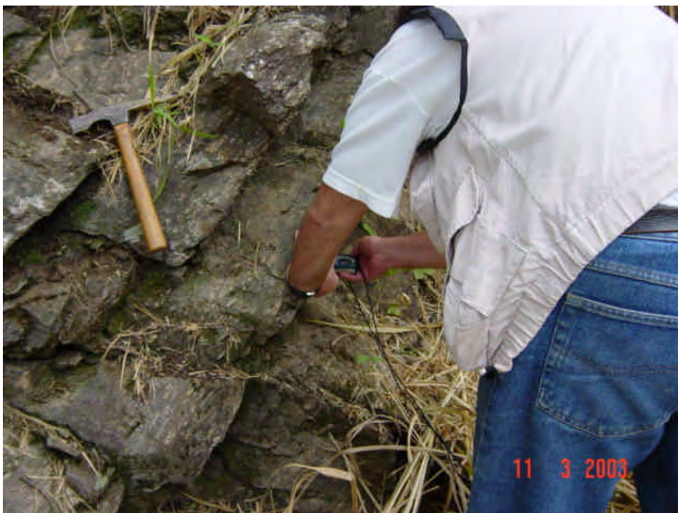
Foto 3.10 Mesmo afloramento. Medição de fraturas
