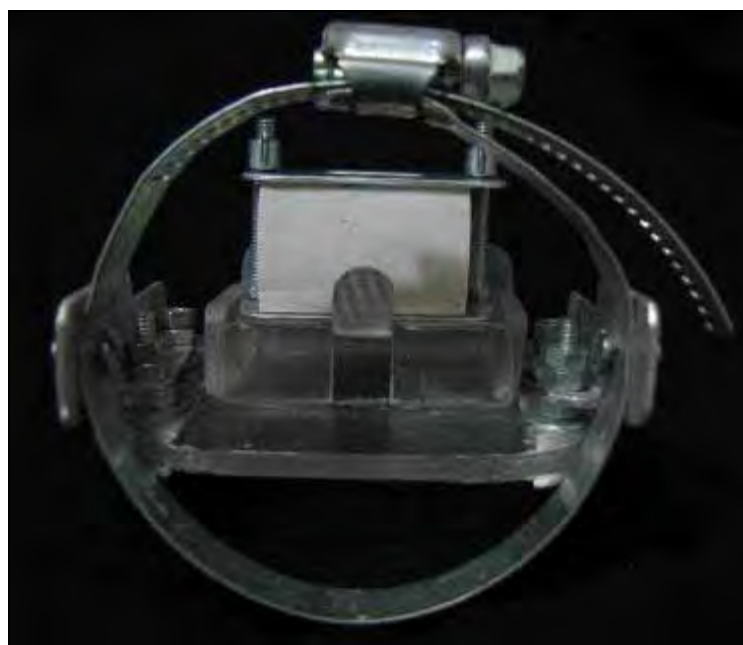
FIGURA 8 - BRAÇADEIRA METÁLICA PARA ENCAIXE NO CONE DO APARELHO DE RAIOS-X.
