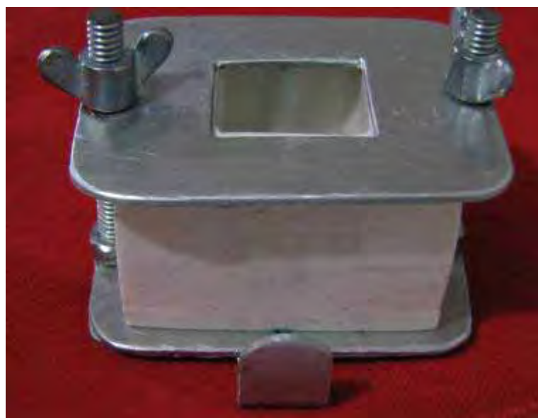
FIGURA 7 - SUPORTE METÁLICO PARA MANUTENÇÃO DO CONJUNTO MOLDE DE SILICONE E BLOCO DE RESINA NA PLATAFORMA RADIOGRÁFICA.
