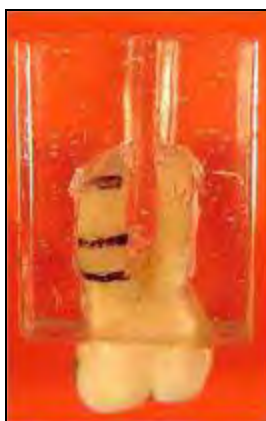
FIGURA 2 - RAIZ MÉLIO-VESTIBULAR INCLUÍDA EM BLOCO DE RESINA.
