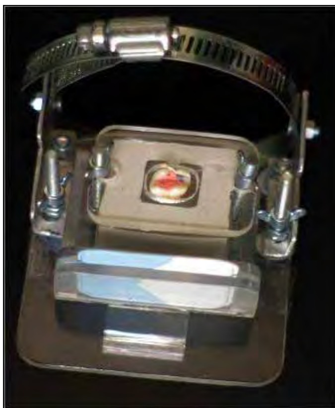
FIGURA 6 - PLATAFORMA RADIOGRÁFICA EM RESINA ACRÍLICA.
