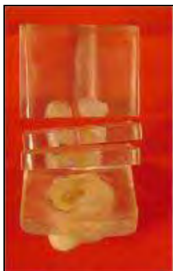
FIGURA 4 - BLOCO DE RESINA SECCIONADO NOS TRÊS TERÇOS.
