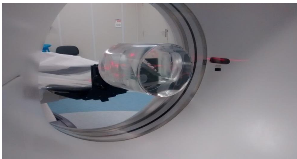
Figura 5: Posicionamento do simulador de acrílico no centro de rotação do gantry.
