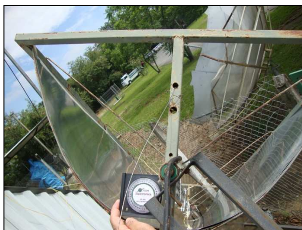
Figura 21 – Acompanhamento manual utilizando um inclinômetro
