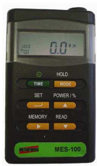
Figura 28 – Medidor de densidade de potência solar
