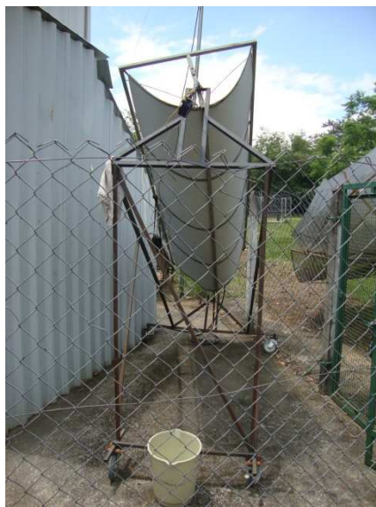
Figura 20 – Instalação de rodas no aquecedor solar
