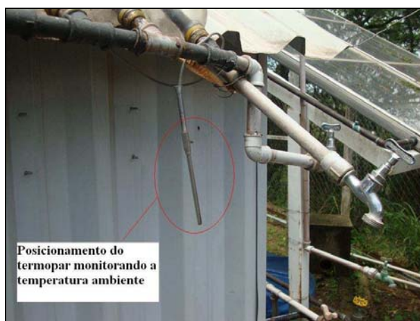
Figura 19 – Monitoramento da temperatura ambiente pelo termopar
