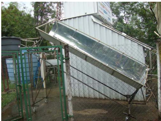
Figura 14 – O projeto inicial do aquecedor solar parabólico cilíndrico
