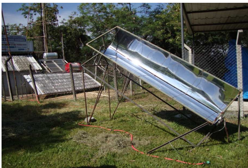
Figura 1 – Aquecedor solar do Centro de Energias Renováveis
