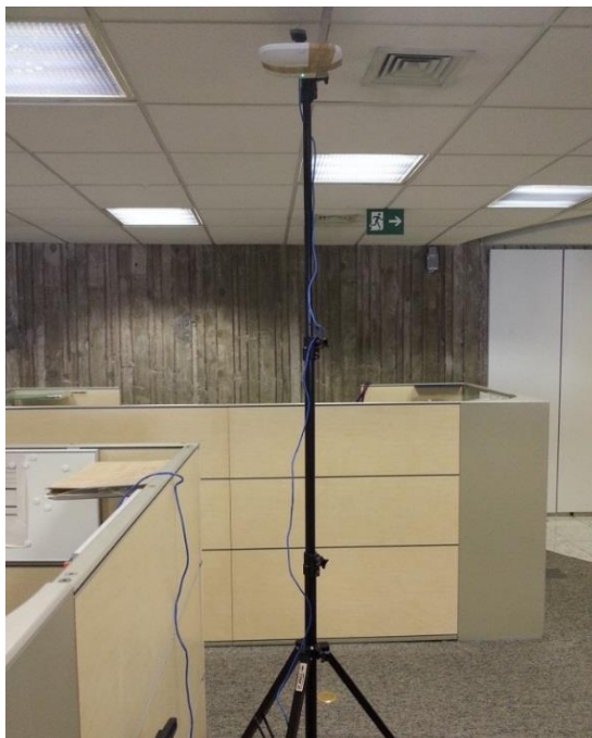
Figura 45 - Simulação da altura de instalação com um tripé
