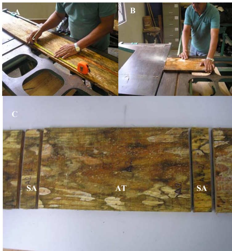
Figura 16. A: Marcação das tábuas. B: Processo de corte. C: Tábua com os cortes para obtenção da amostra teste (AT) e das sub-amostras (SA).
