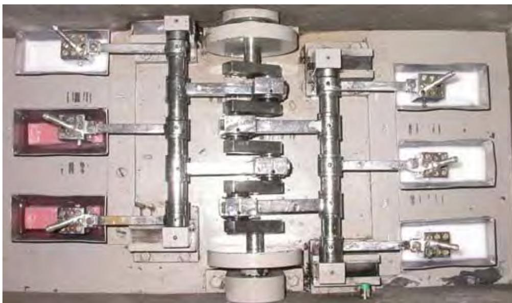
FIGURA 2 – Máquina simuladora de escovação
