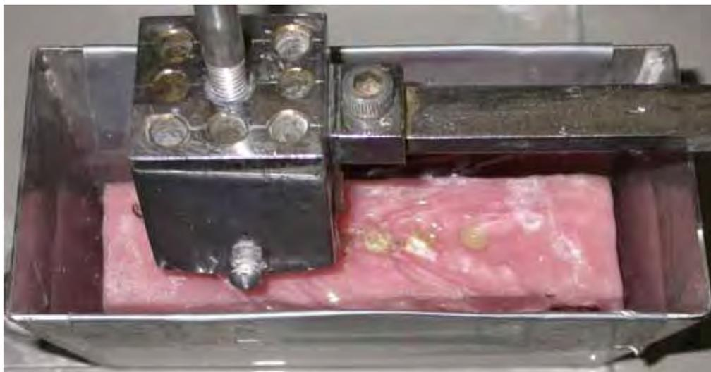
FIGURA 3 – Dispositivo contendo as amostras e adaptado à máquina
