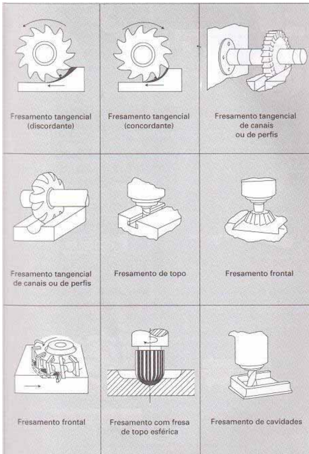
Figura 8 - Principais operações executadas na fresadora. Machado et al (2009)
