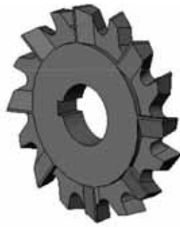
Figura 19: Fresa cilíndrica de disco de dentes cruzados. Stemmer (1992).
