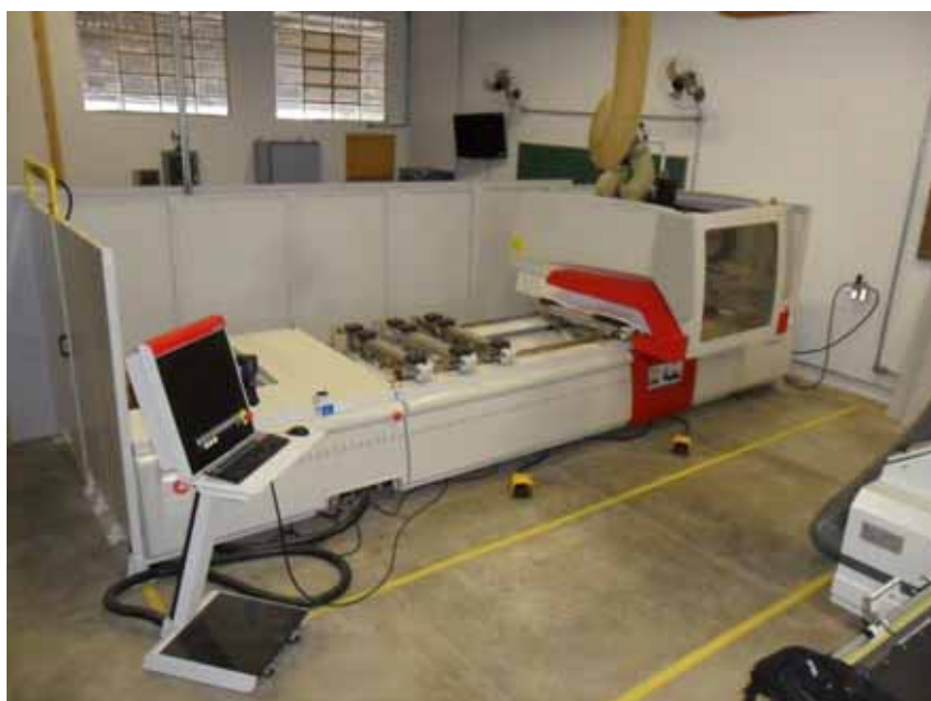
Figura 41 - Furadeira – Fresadora CNC Tech Z1 (SCM GROUP S. P. A. – Manual de Instruções; ALMEIDA, 2013)
