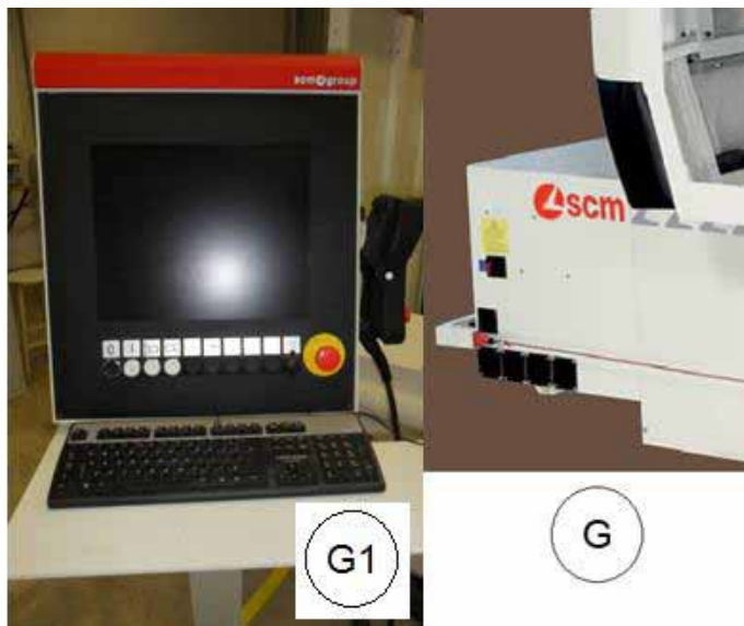
Figura 33 - Armário elétrico G e painel de controle móvel G1 (Catálogo TECH Z1 2011-adaptado).
