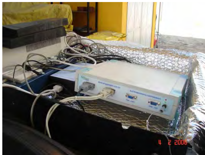
Figura 13 - Equipamento para aquisição de sinais da EMG System, ligado ao condicionador de sinais, que se liga ao acelerômetro.
